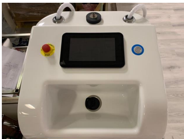
Figura 7: Pannello superiore del WIB. Si notano i fori e le giunzioni.
