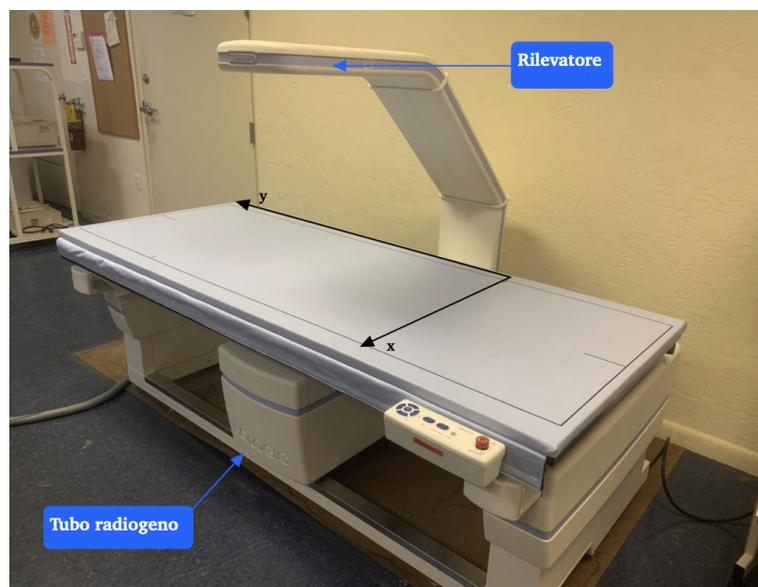
**Figura 1.5:** Schema delle parti principali dello scanner DXA Horizon (Hologic). Sono indicate le posizioni di tubo e rivelatore. Il tavolo si sposta lungo la direzione indicata come  $x$ , mentre il braccio a C (rilevatore e tubo radiogeno) si spostano lungo la direzione indicata come  $y$ .
