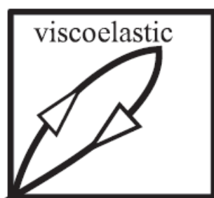
Figura 14: Curva sforzo-deformazione di un materiale viscoelastico [25].
