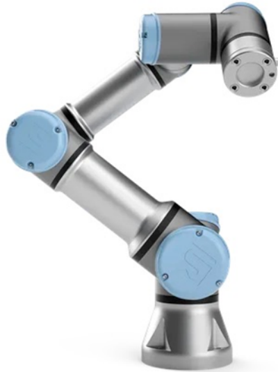
Figura 6.2 Cobot UR3e utilizzato nelle prove sperimentali ( https://www.universal-robots.com/products/ur3-robot/ )
