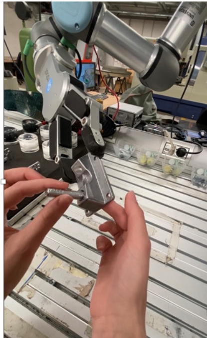
Figura 6.11 Esempio di istruzione mostrata ai partecipanti all'inizio della prova di assemblaggio nella condizione che prevede l'utilizzo del cobot. Il robot collaborativo ha compiuto una precedente attività di pick del componente e il partecipante come prima attività deve inserire il bullone nel foro
