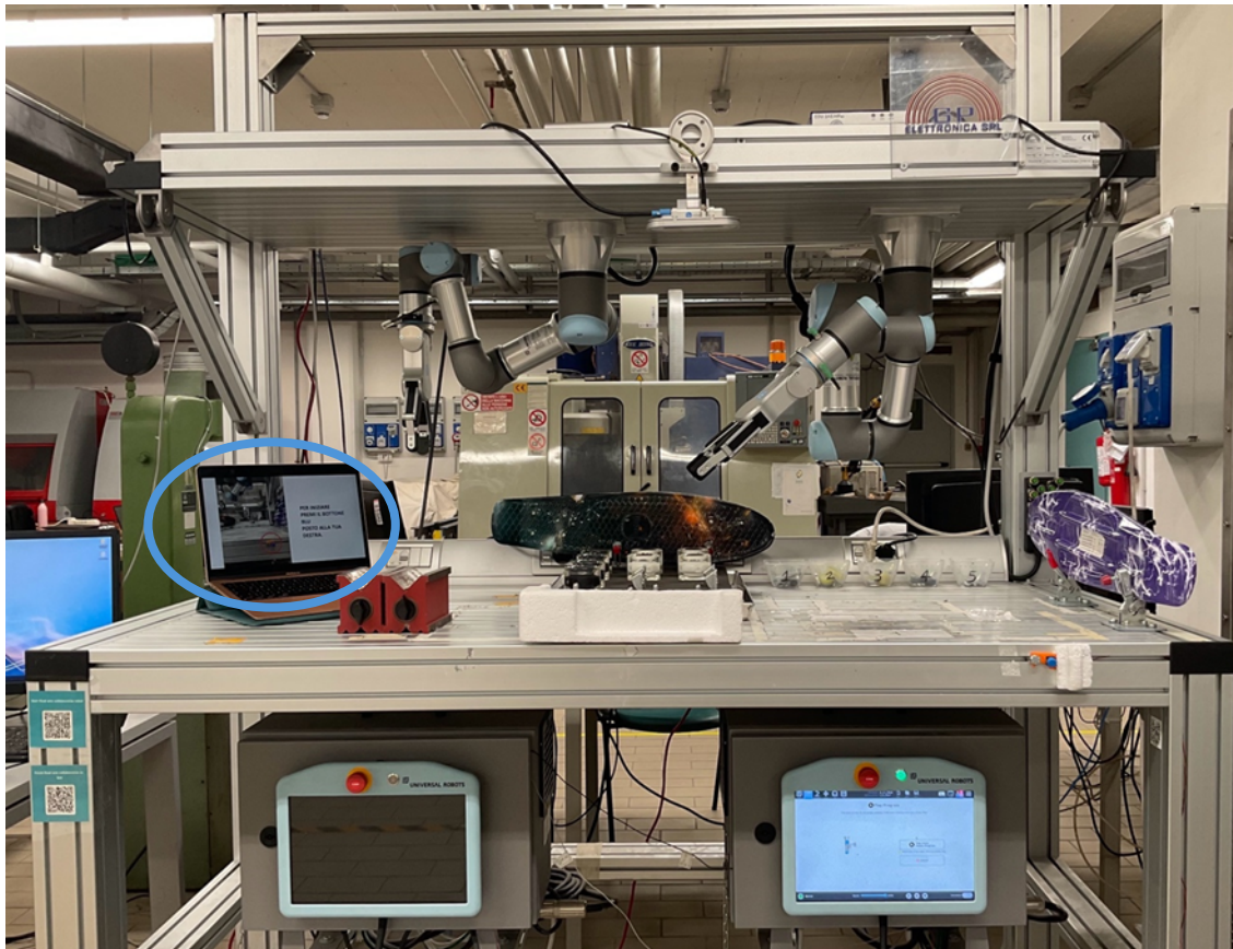
Figura 6.10 Setup dell'esperimento. Da come si può vedere il computer mostra le istruzioni ed è posizionato all'estrema sinistra del banco di lavoro, in modo tale da non risultare di impedimento ai partecipanti per il corretto svolgimento dei tasks e da non ostacolare il movimento del cobot.
