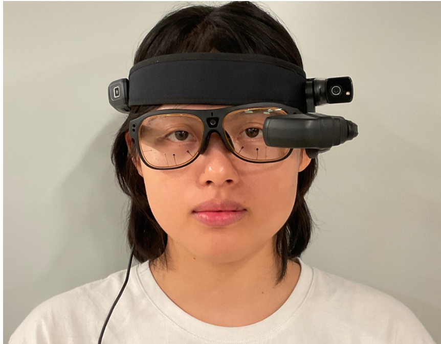
Figura 6.6 Foto di una partecipante che indossa Tobii Pro Glasses 3 con RealWear durante una condizione di assemblaggio proposta
