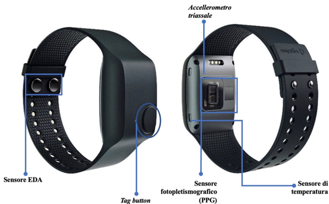
Figura 6.7 Empatica E4 e i sensori di cui si compone
