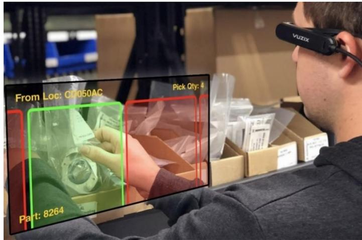
*Figura 1.6: Tecnologia AR a supporto di operazione di order picking («Five Reasons to Invest in Enhanced Vision Technology for Your Warehouse | SupplyChainBrain», s.d.)*
