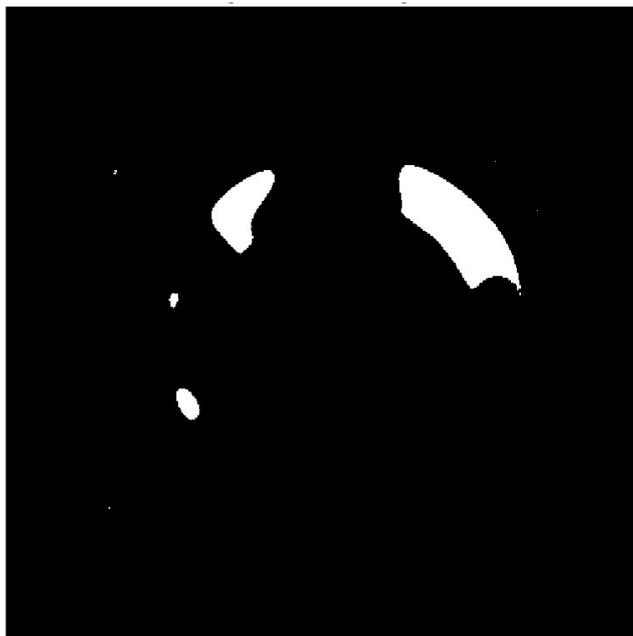
*Fig.60* Binarizzazione dell'immagine in *Fig.59* tramite sogliatura globale (A16).
