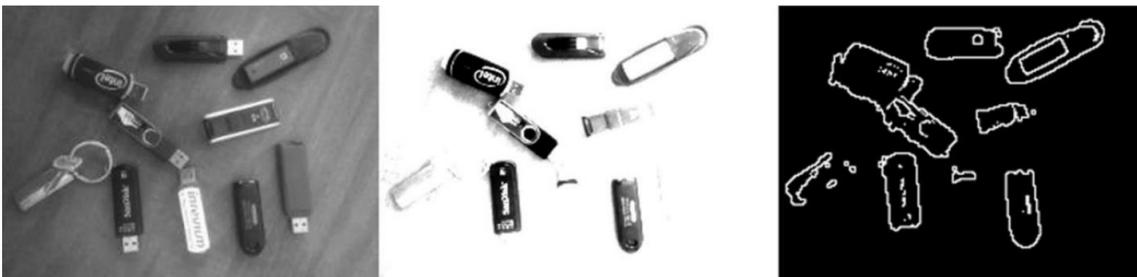
Fig.39 L'importanza del *preprocessing* in una serie di immagini: per passare dall'immagine originale (sinistra) a quella post-soglia (destra), è stato necessario applicare un processo intermedio (centro) di isolamento del canale rosso dell'immagine in input [70].
