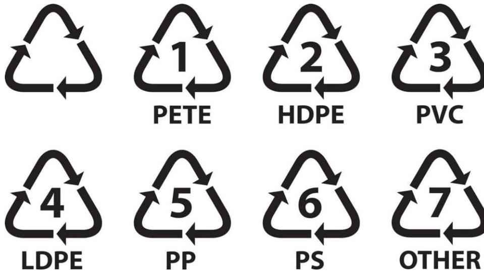
*Fig.28 Simbologia numerica delle plastiche [61].*
