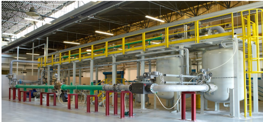
Figura 39: Banco di prova sperimentale per la valutazione del coefficiente di portata Gibson
