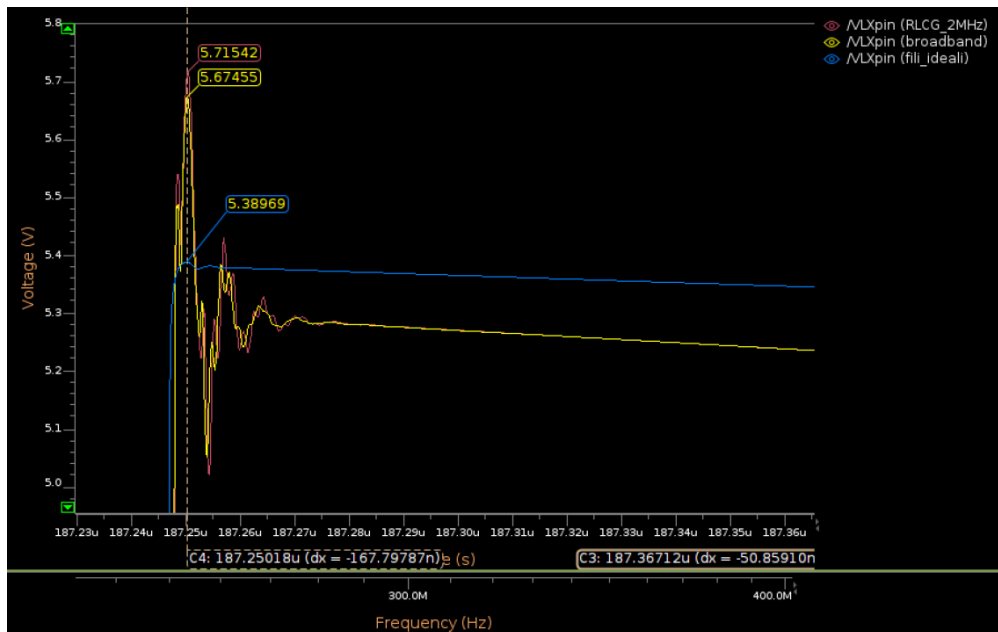
Figura 5.18: VLXpin (pin 9), zoom sul ringing dell'immagine precedente.
