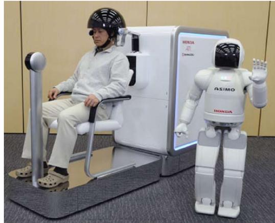
Figura 9 Controllo del robot umanoide Asimo mediante BCI
