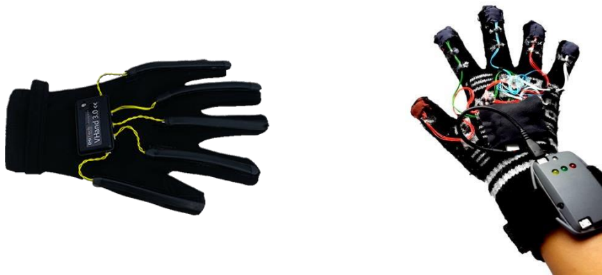
Figura 5 Due tipi di modelli di Data Glove per il tracciamento dei movimenti della mano e delle dita
