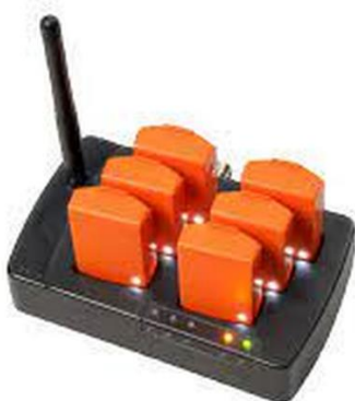
Figura 12 Host che permette il collegamento di Xsens e computer
