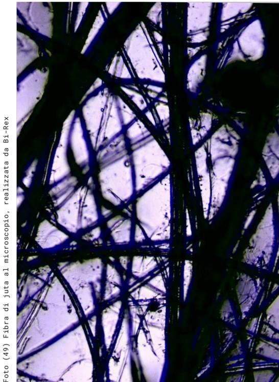
Foto (49) Fibra di juta al microscopio, realizzata da Bi-Rex
