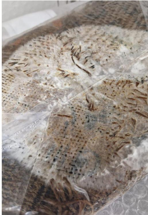
Foto (46) Micelio su pannello in fase di asciugatura, realizzata da BioArtLab
