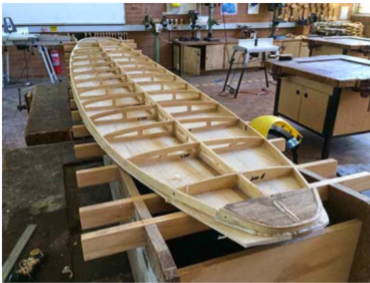
Fig. 1 Struttura interna tipica delle tavole da surf in legno
