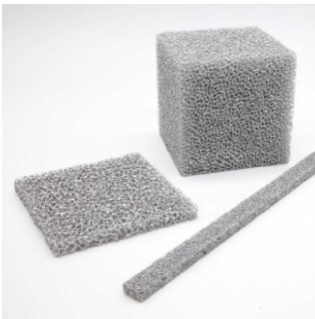
Fig.3 Forme di aluminum foam
