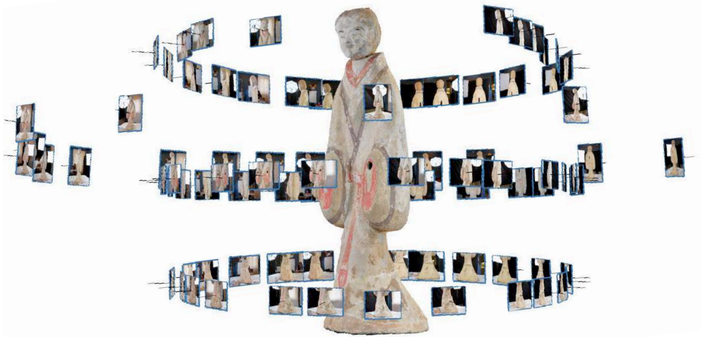
Figura 4. Ricostruzione del modello 3D con Agisoft® Metashape, dettaglio posizionamento camere
