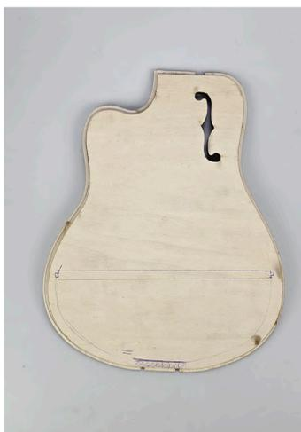
Fig.79: Prime prove di taglio del kerf, che risulta rigido e fragile
