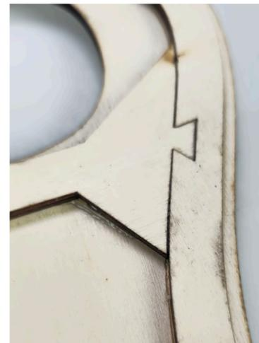
Fig.87: Incastro a dente di cane Top
