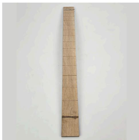
Fig.128: Fret incollato tramite colla espansiva
