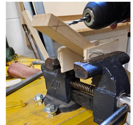
Fig.117: Creazione dei fori per il passaggio delle corde
