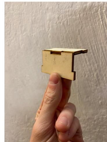
Fig.69: Provino di incastro con parametri di taglio ancora da perfezionare
