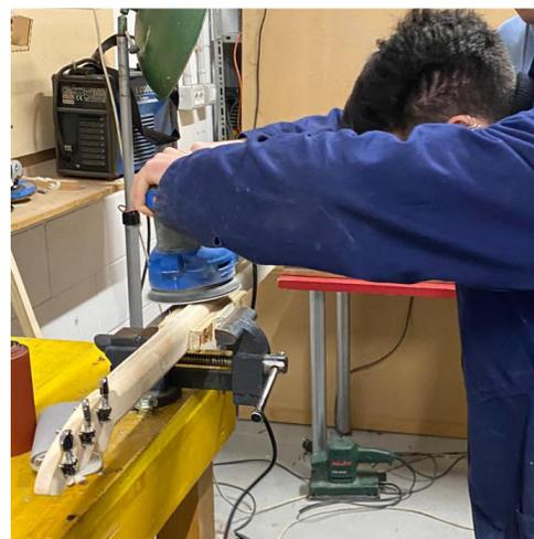
Fig.139: Attraverso l'uso della levigatrice si livellano le superfici del manico e della tastiera
