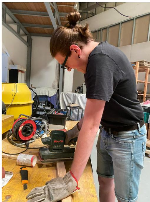
*Fig.5: Levigatura con levigatrice manuale di un travetto di recupero per la creaziione del manico*
