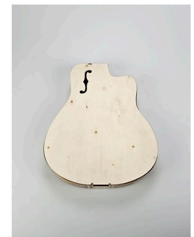
Fig.78: Body Modello Classico assemblato
