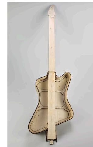
Fig.118: Montaggio del manico di prova
