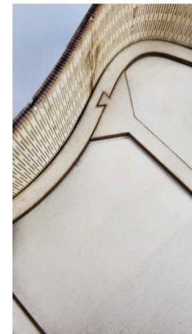
Fig.88: Incastro a dente di cane cassa armonica
