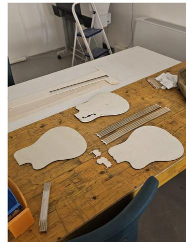
Fig.75: Componenti del body modello Classico appena tagliati a laser
