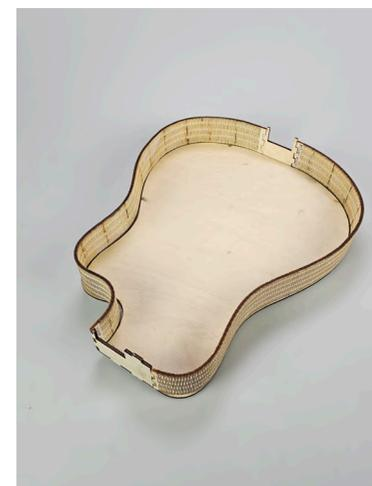
Fig:77: Body assemblato senza il top
