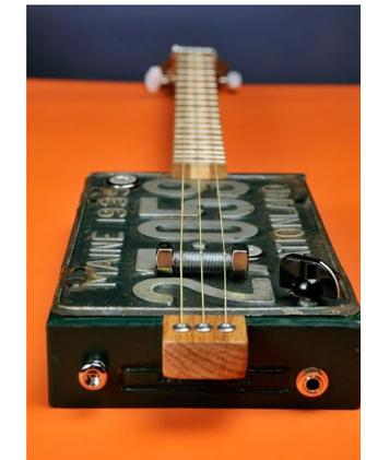
Fig.56: Ponte di una Cigar Box Guitar fatto usando una barra filettata
