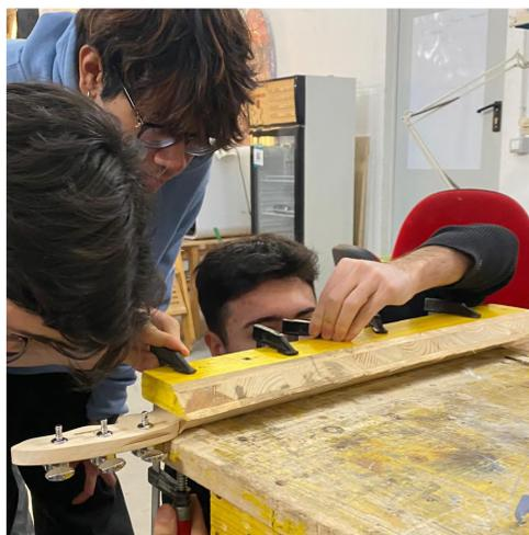
Fig.138: Tramite dei morsetti si crea pressione per far aderire meglio la tastiera al manico
