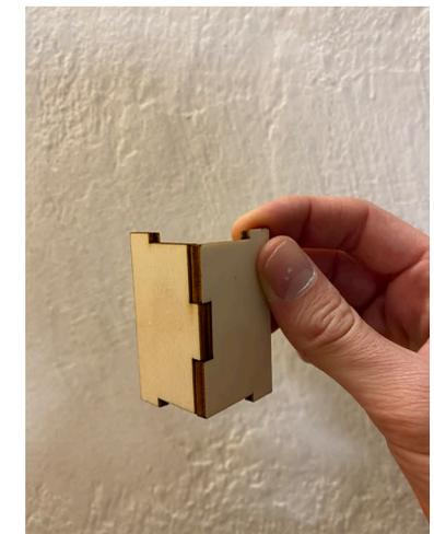
Fig.70: Provino di incastro ottimizzato
