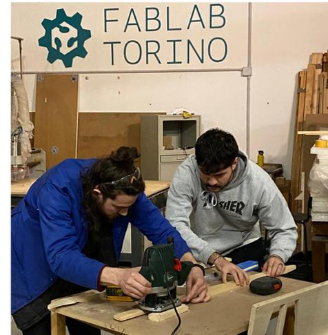
Fig.134: Creazione della smussatura del manico tramite il banco fresa
