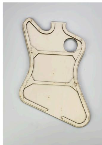
Fig.80: Kerf funzionale alla curvatura grazie ad una buona proporzione e buon taglio
