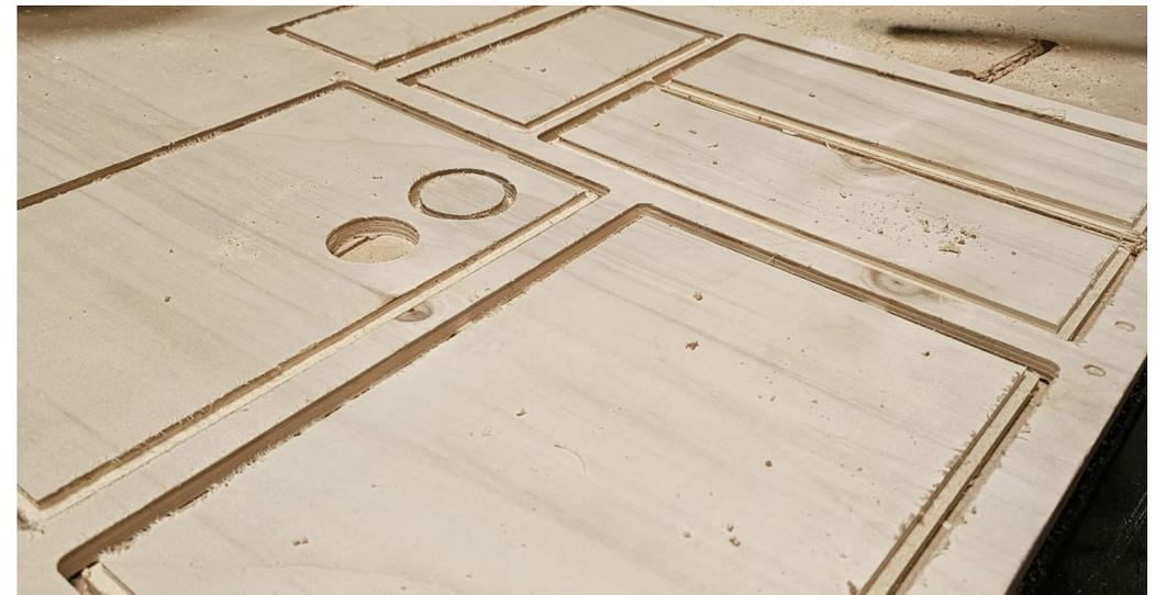
Fig.4: Taglio della Cigar Box Guitar in legno multiistrato tramite la fresatrice CNC
