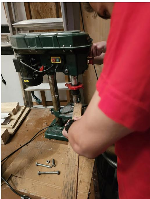
Fig.9: Creazione dei fori nella paletta tramite trapano a colonna
