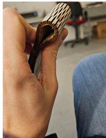
Fig:72: Kerf funzionale alla curvatura grazie ad una buona porzione e buon taglio
