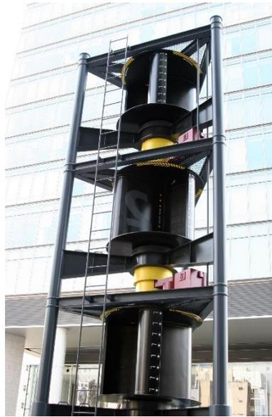
Figura [9]: *Impianto eolico a turbina Savonius multipla,*
