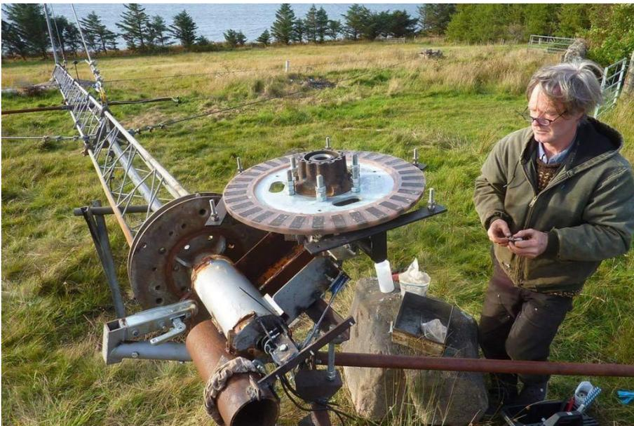
Figura [55]: *Hugo Piggott durante l'assemblaggio di una sua turbina, windempowerment.org*
