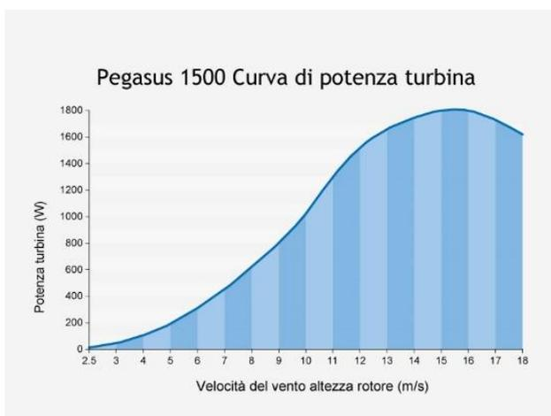
Figura [35]: Grafico della curva di potenza della turbina Pegasus 1500, etneo.com
