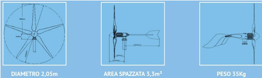
Figura [33]: Schema dimensioni e peso della turbina Pegasus 1500, etneo.com
