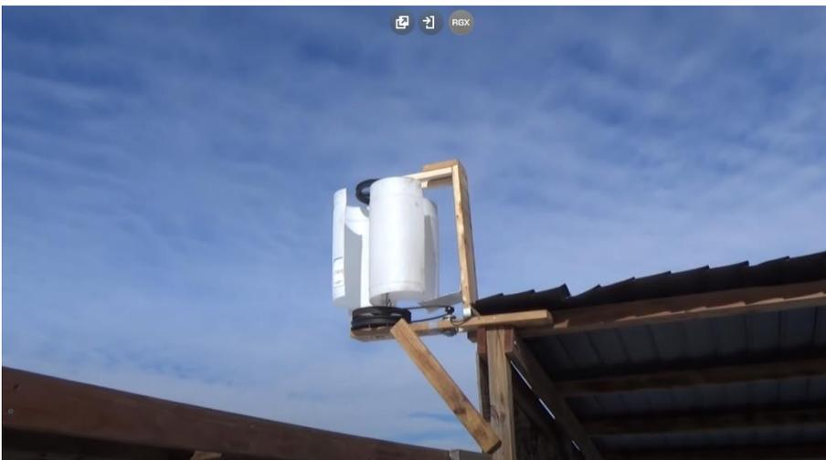
Figura [60]: Turbina Savonius di barili installata sul tetto del realizzatore, youtube.com
