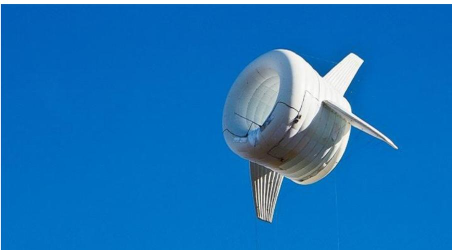
Figura [15]: *Turbina eolica a volo libero,*
