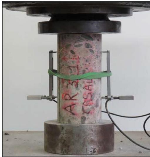
*Figura 3.7 - Configurazione finale test per determinazione del modulo elastico*
