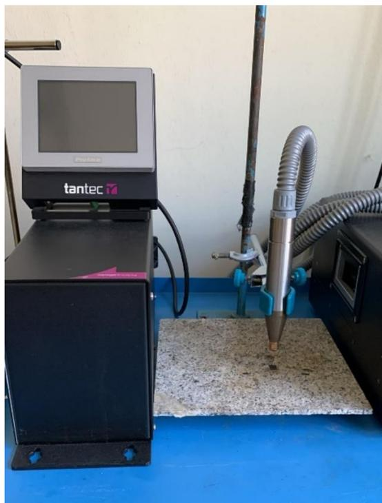
**Figura 2.5:** PlasmaTEC-X OEM – Plasma atmosferico.
