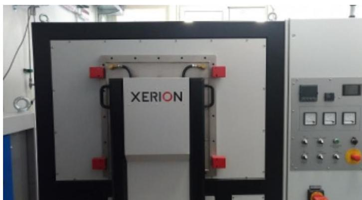
**Figura 2.2:** Fornace sottovuoto XVAC [37].
