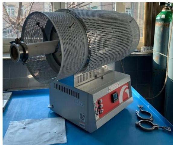
**Figura 2.7:** Carbolite Gero STF 16/180 forno tubolare.
