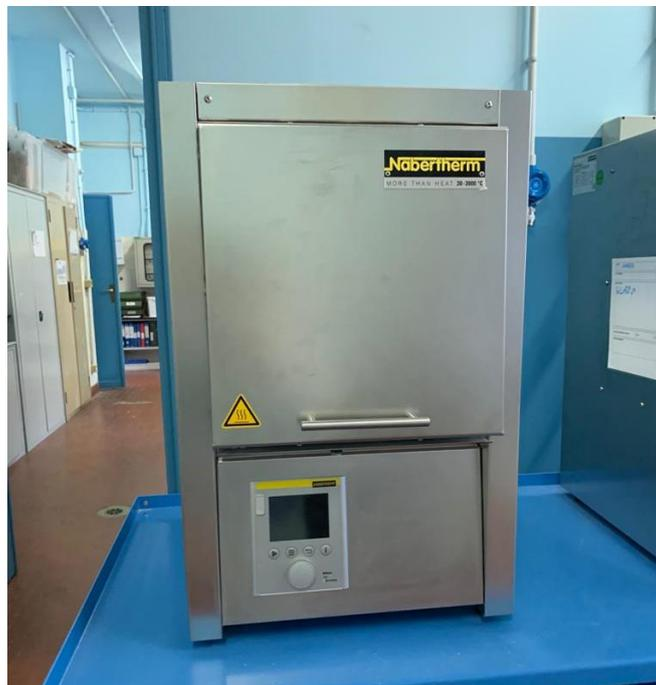
**Figura 2.8:** Nabertherm 1300 fornace ad aria.
