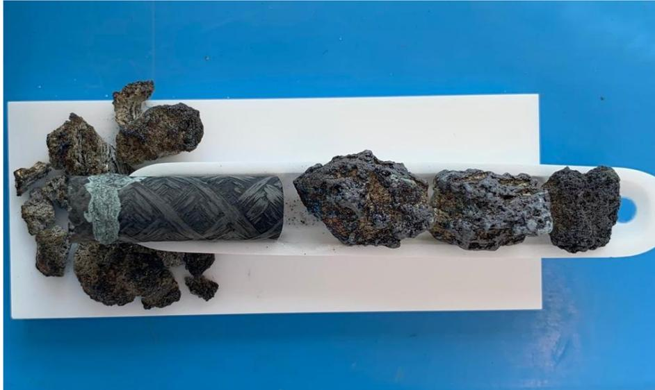
**Figura 3.18:** Sistema tubo tappo giuntato con fibre di SiC.
