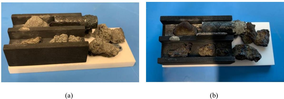
**Figura 3.12:** Sistema tubo-tappo giuntato, dopo reticolazione (a) e dopo pirolisi e sinterizzazione(b).
