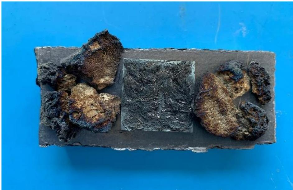
**Figura 3.10:** Precursore di carburo di silicio miscelato con fibre di SiC dopo pirolisi.
