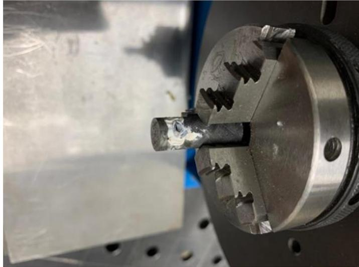
**Figura 3.21:** Campione dopo saldatura laser.
