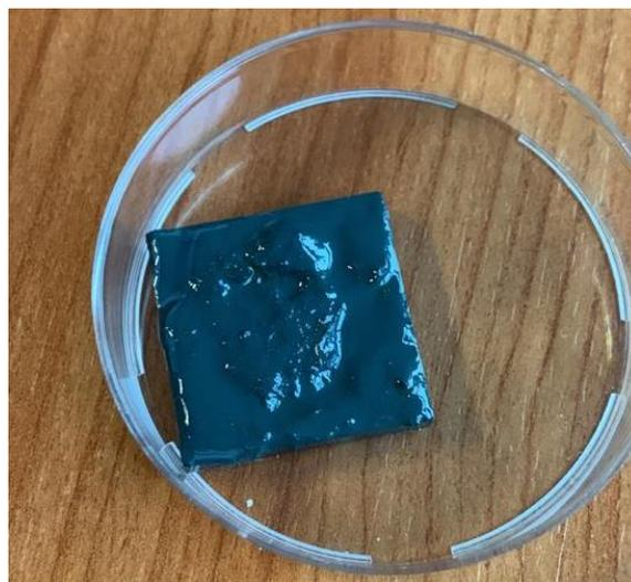
**Figura 3.7:** Precursore di carburo di silicio post trattamento in stufa.
