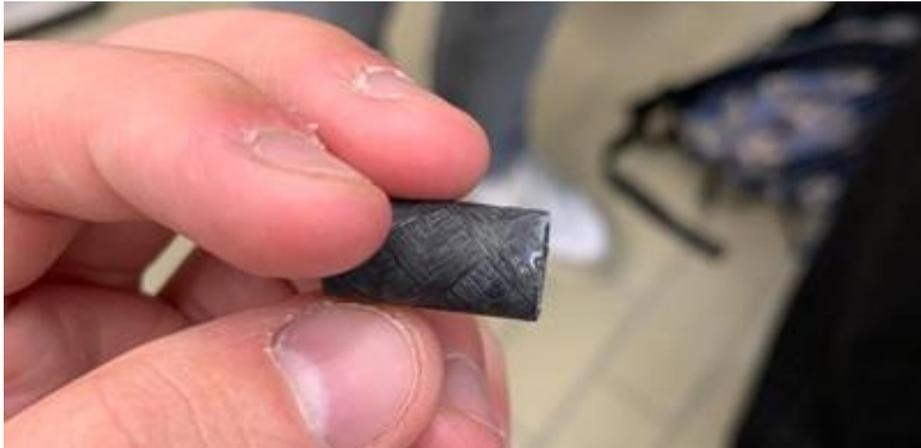
**Figura 3.20:** Tubo dopo trattamento laser (non si è legato al tappo).
