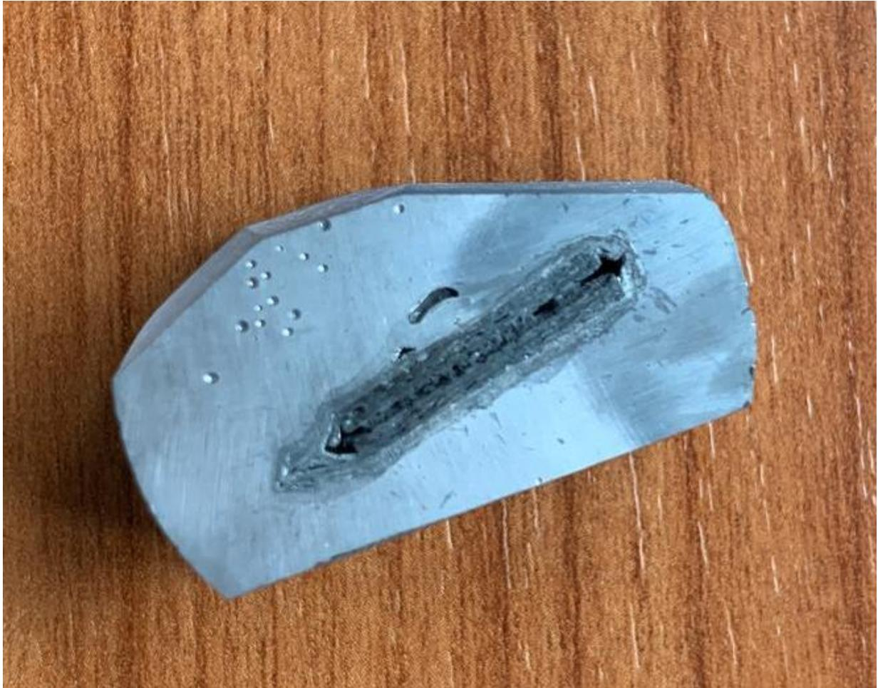
**Figura 3.16:** Campione giuntato dopo inglobamento in resina, taglio e lucidatura.
