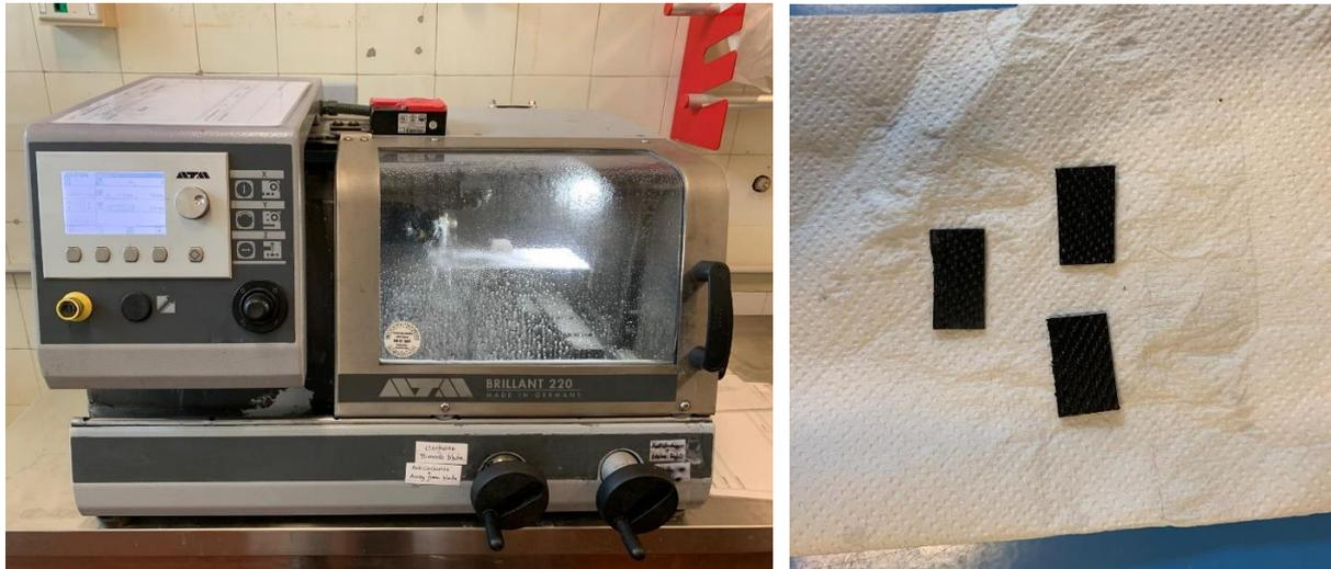
**Figura 2.4:** Taglio della lastra di  $\text{SiC}_f/\text{SiC}$  in substrati adatti con la Brillant 220.
