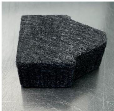
**Figura 2.1:** Blocco di fibre di carbonio.
