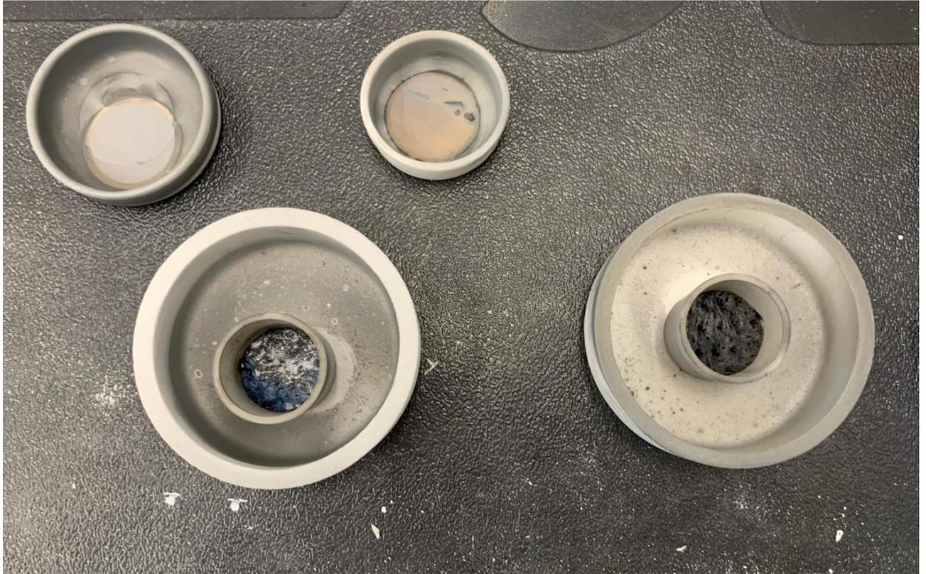
**Figura 3.1:** Fibre di C e il silicio nei due sistemi dopo trattamento termico.
