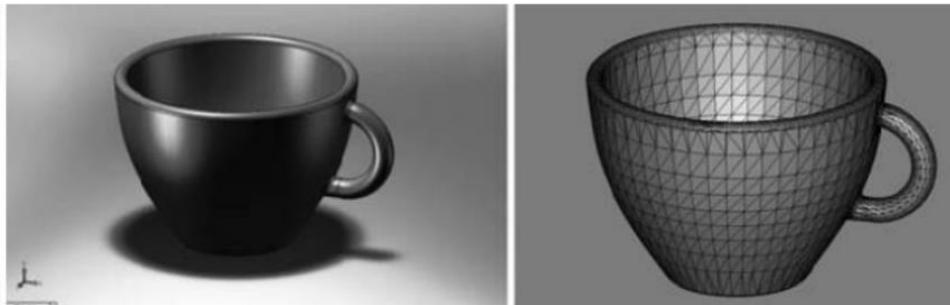
*Figura 1.5: Un file CAD [sx] convertito in un file formato STL (dx)*
