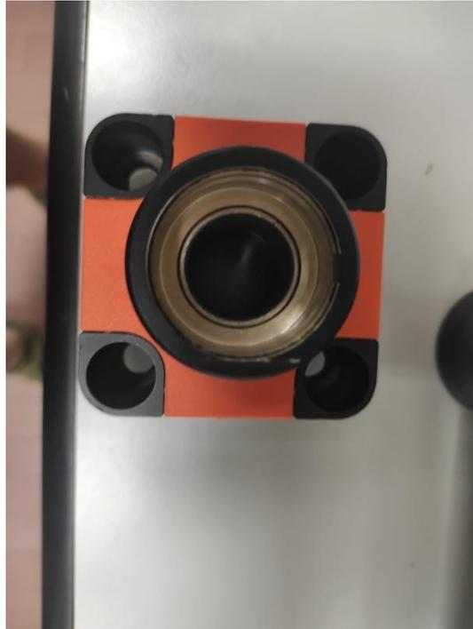
Figura 16: Testata attuatore pneumatico
