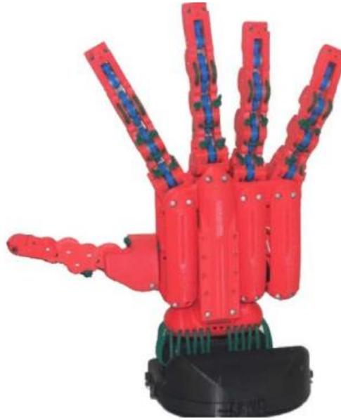
Figura 1.15 Prototipo della Pisa/IIT SoftHand [29]
