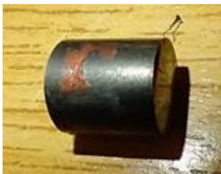
Figura 2.14 inserto in grafite smontato dal porta provino di Figura 2.13, silicone non presente.
