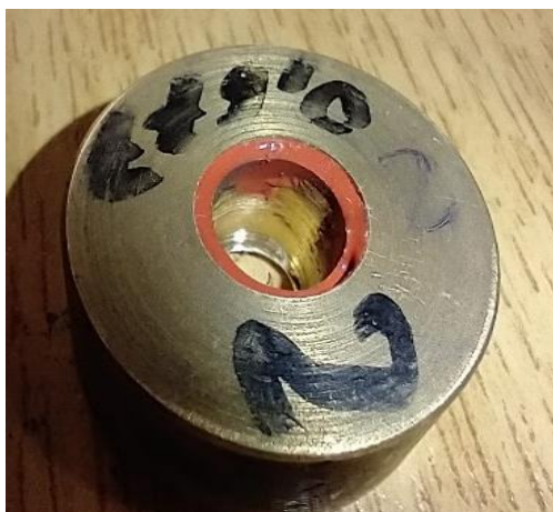
Figura 2.13 porta provino con materiale adesivo solo sul lato di montaggio
