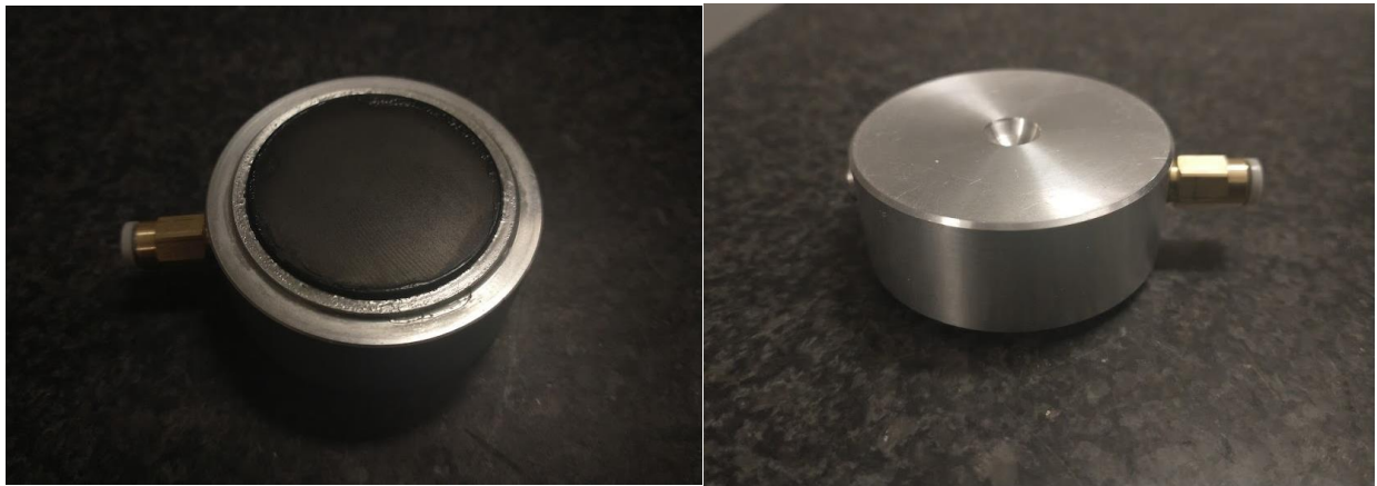
Figura 3.14 pattino pneumostatico poroso corpo in alluminio, sulla destra particolare dell'inserto montato
