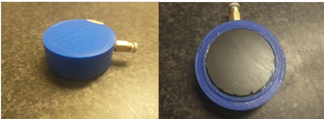
Figura 3.15 pattino pneumostatico poroso corpo pla ottenuto tramite stampa 3D, sulla destra particolare dell'inserto montato
