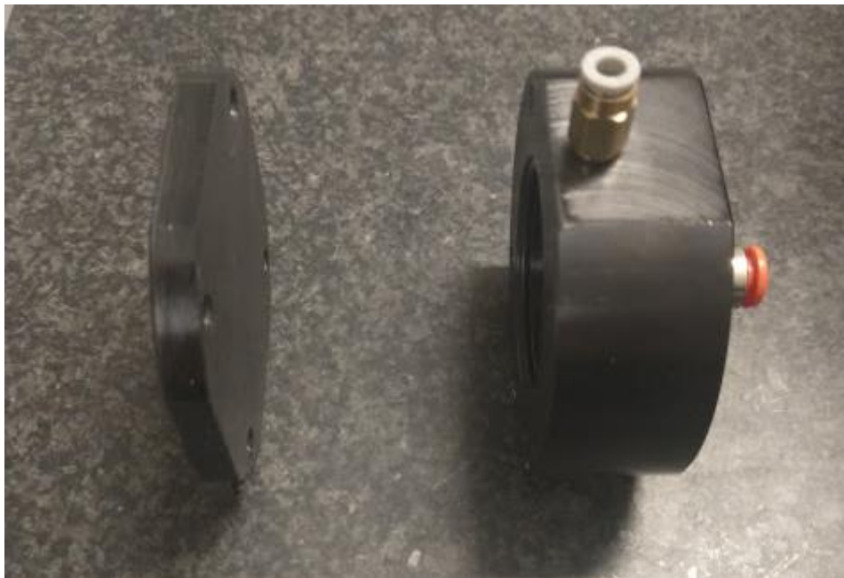
Figura 3.1 banco permeabilità pattino, a sinistra la piastra di fissaggio sulla destra la flangia di scarico
