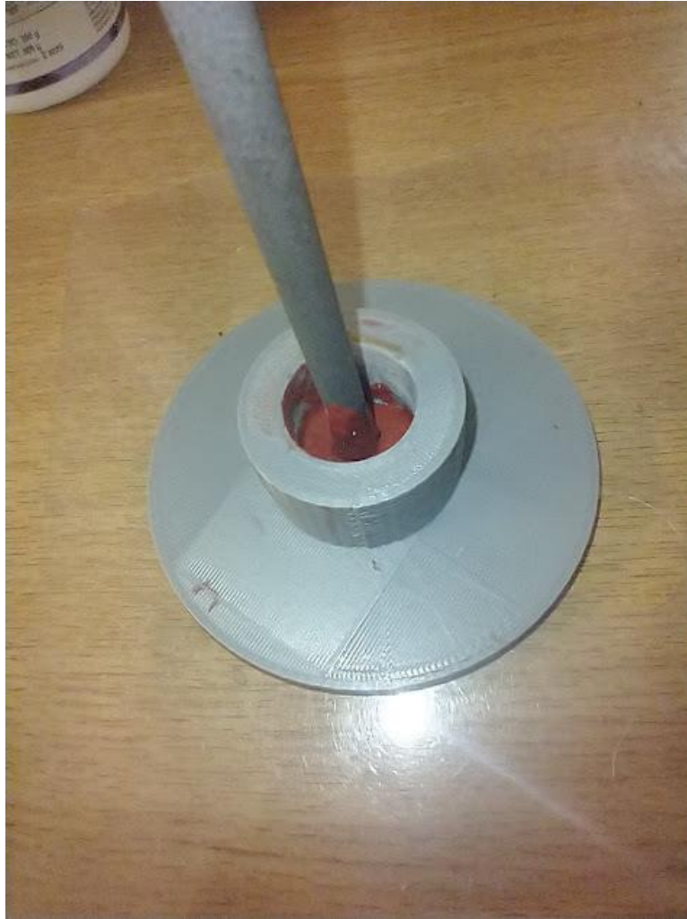
Figura 2.17 particolare posa della colla siliconica nella base inferiore dima stampo provini
