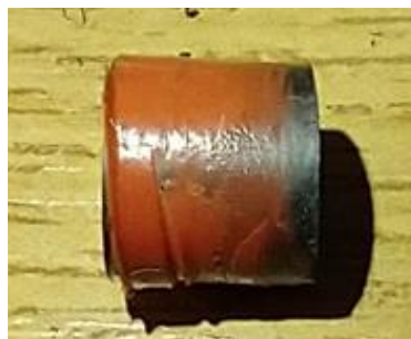
Figura 2.12 inserto in grafite smontato dal porta provino con silicone distribuito in maniera disuniforme sulla superficie
