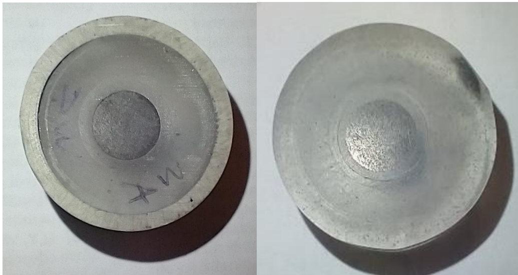
Figura 2.18 provino pronto per essere testato sul banco, sulla sinistra GRAFITE 25 sulla destra GRAFITE 27
