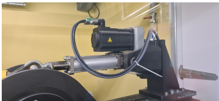
Figura 2.17: Attuatore elettromeccanico attualmente montato sul banco prove
