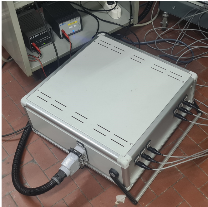
Figura 6.1: Rack contenente i sensori per misurare i segnali di tensione e corrente
