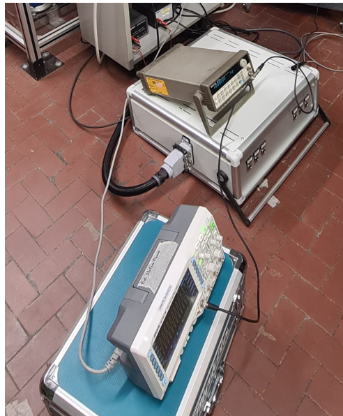
Figura 5.1: Postazione adottata per verificare i segnali: in basso l'oscilloscopio e, sopra al rack di acquisizione, il generatore di segnale.
