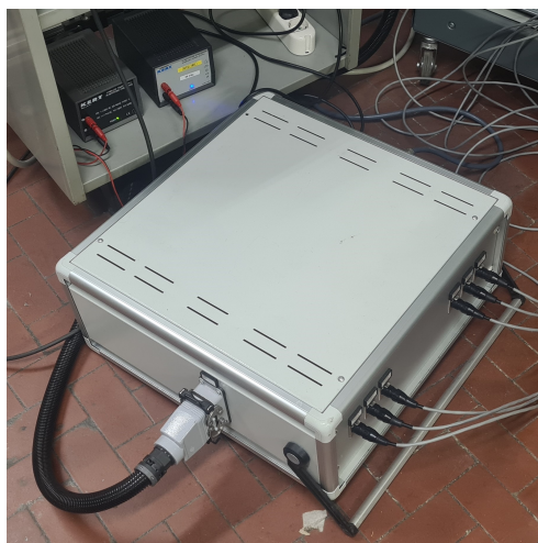
Figura 2.36: Rack contenente i sensori di tensione e corrente
