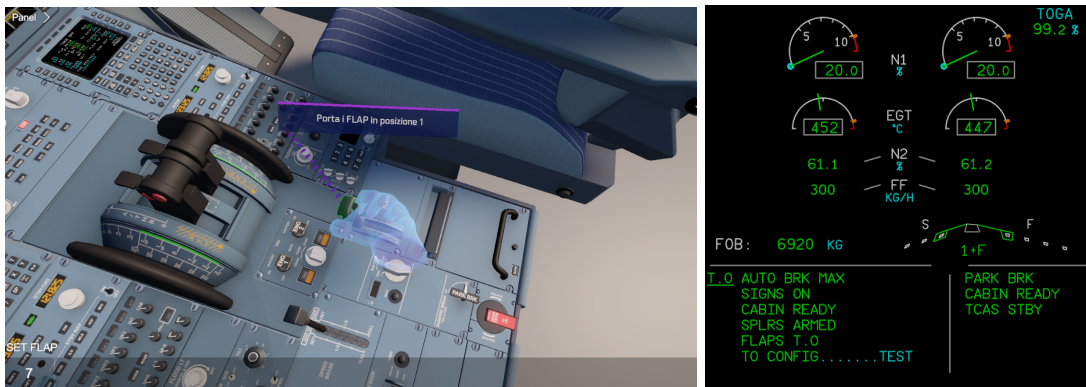
Figura 5.19: A sinistra, visualizzazione, in modalità Game di Unity, del nodo SET FLAP; a destra, visualizzazione del pannello ECAM con checklist spuntata.
