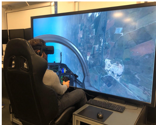
Figura 2.7: La versione più evoluta di Simulation Based Trainer (SBT), dotata di visori per Virtual Reality e guanti tattili.
