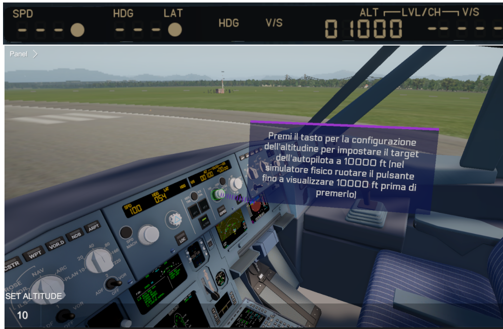
Figura 5.21: In alto, il pannello da cui si controlla l'altitudine; in basso, visualizzazione, in modalità Game di Unity, del nodo SET ALTITUDE.
