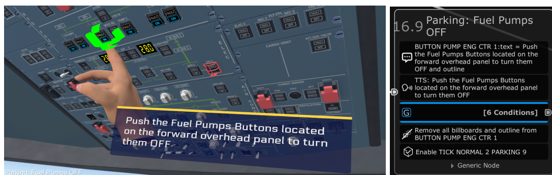
Figura 4.12: Nodo di spegnimento delle Fuel Pumps con interfaccia Game di Unity a sinistra e WeaVR a destra.
