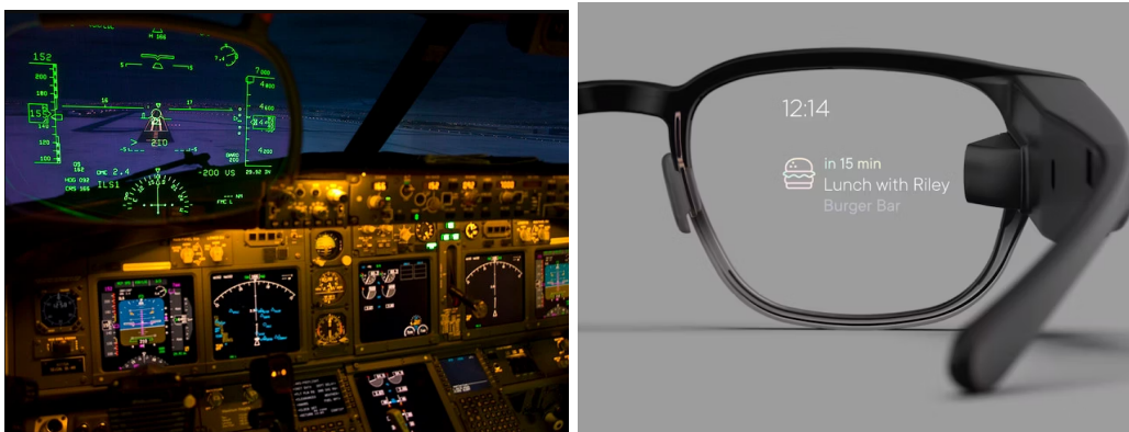
Figura 2.3: A sinistra, applicazione dell'Heads up Display su un Boeing 737 in fase di atterraggio; a destra, la lente degli Smart glasses
