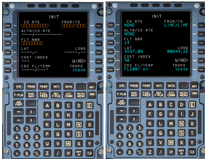
Figura 5.9: A sinistra, la schermata INIT dell'MCDU ancora da completare; a destra la stessa schermata completata.
