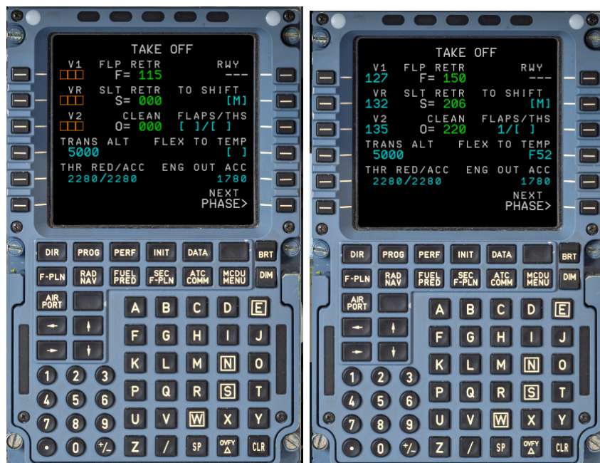
Figura 5.11: A sinistra, la schermata PERF dell'MCDU ancora da completare; a destra la stessa schermata completata.
