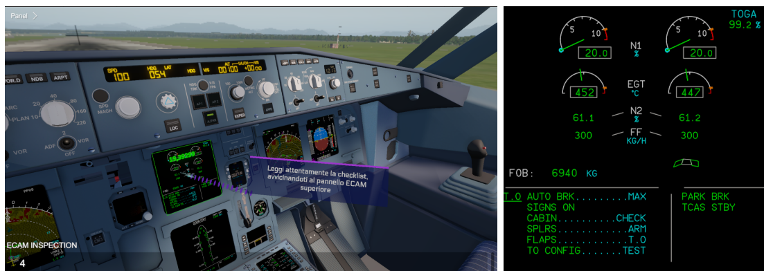
Figura 5.16: A sinistra, visualizzazione, in modalità Game di Unity, del nodo ECAM INSPECTION; a destra, visualizzazione del pannello ECAM.
