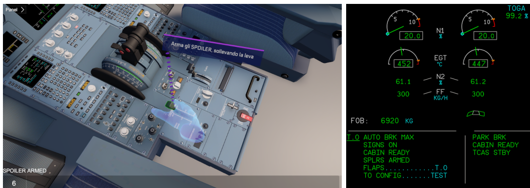
Figura 5.18: A sinistra, visualizzazione, in modalità Game di Unity, del nodo SPOILER ARMED; a destra, visualizzazione del pannello ECAM con checklist spuntata.
