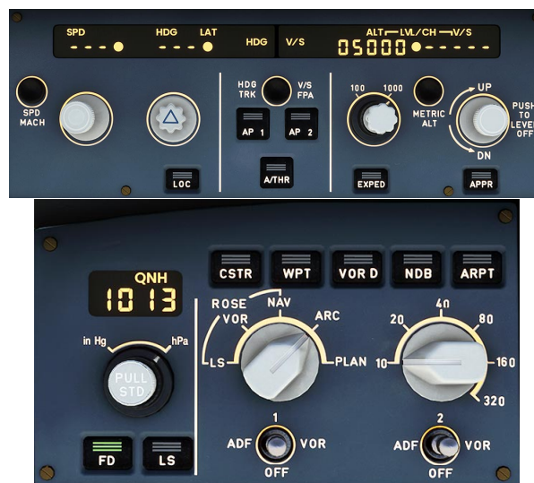
Figura 3.4: In alto, il Flight Control Unit; in basso, l'EFIS control.
