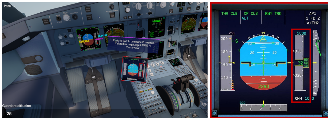
Figura 5.35: A sinistra, la visualizzazione, in modalità Game di Unity, del nodo Guardare altitudine; a destra, il PFD con altitudine evidenziata.
