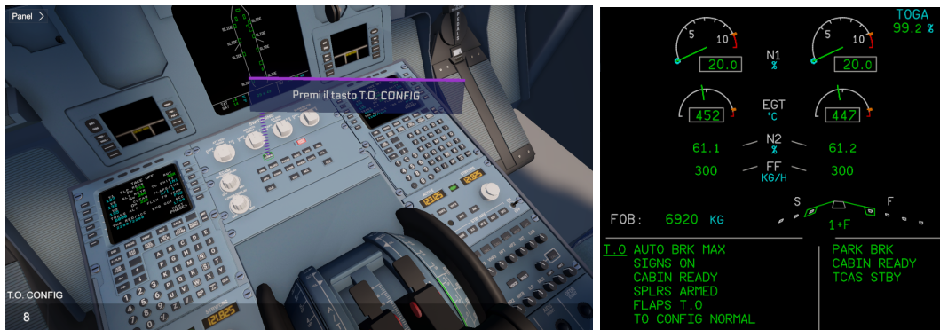
Figura 5.20: A sinistra, visualizzazione, in modalità Game di Unity, del nodo T.O. CONFIG; a destra, visualizzazione del pannello ECAM con checklist spuntata.
