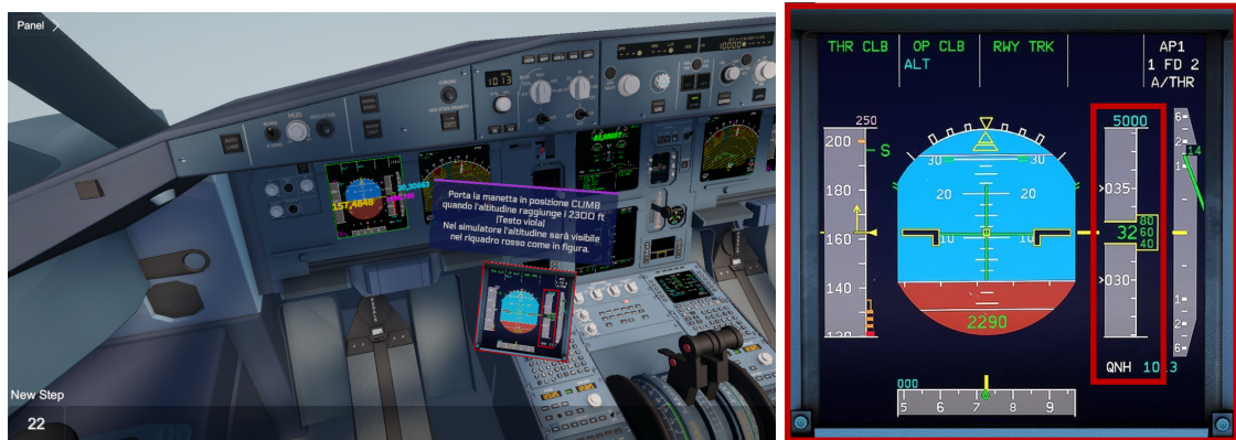
Figura 5.32: A sinistra, la visualizzazione, in modalità Game di Unity, del nodo Guardare altitudine; a destra, il PFD con altitudine evidenziata.
