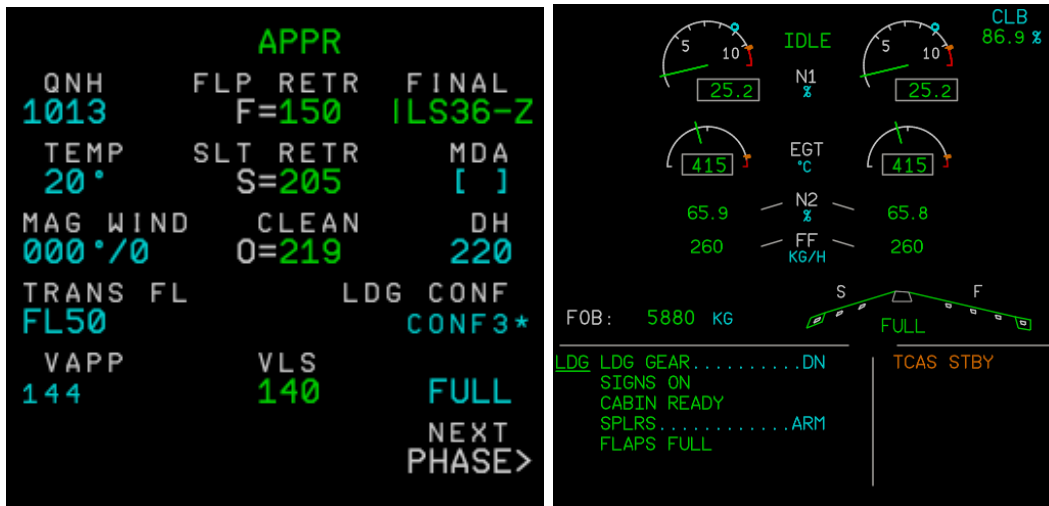
Figura 5.38: A sinistra, la schermata PERF APPR dell'MCDU; a destra, la checklist nel display ECAM prima dell'atterraggio.
