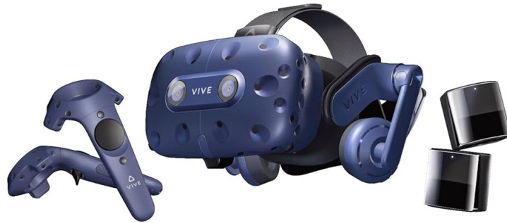
Figura 3.1: HTC Vive Pro Kit, dotato di visore, due controllers e due base stations.
