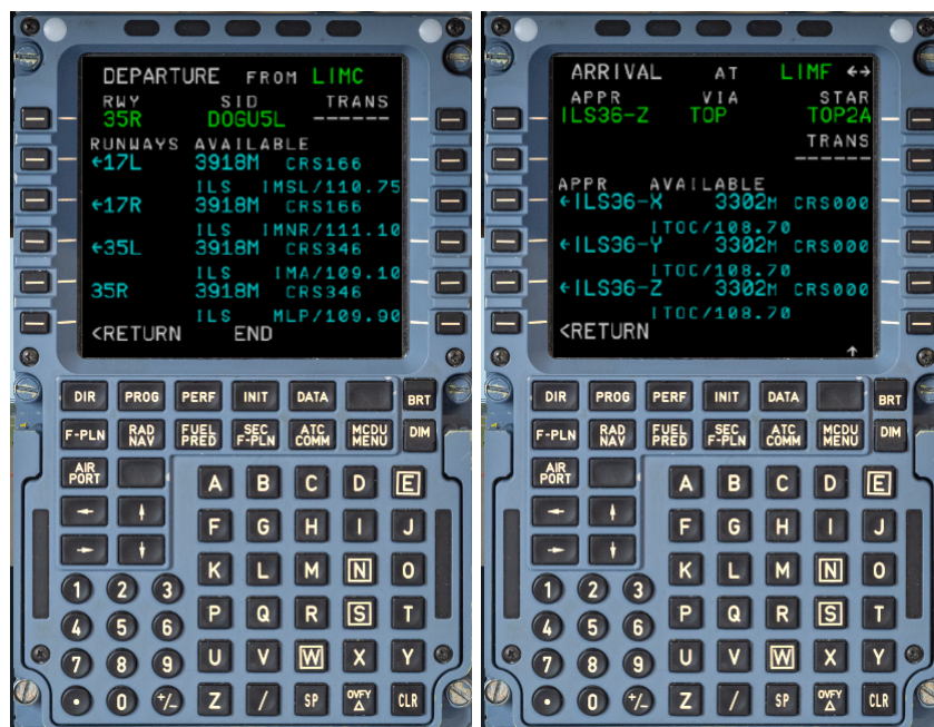
Figura 5.10: A sinistra, la schermata F-PLN dell'MCDU di LIMC completata; a destra la schermata LIMF completata.
