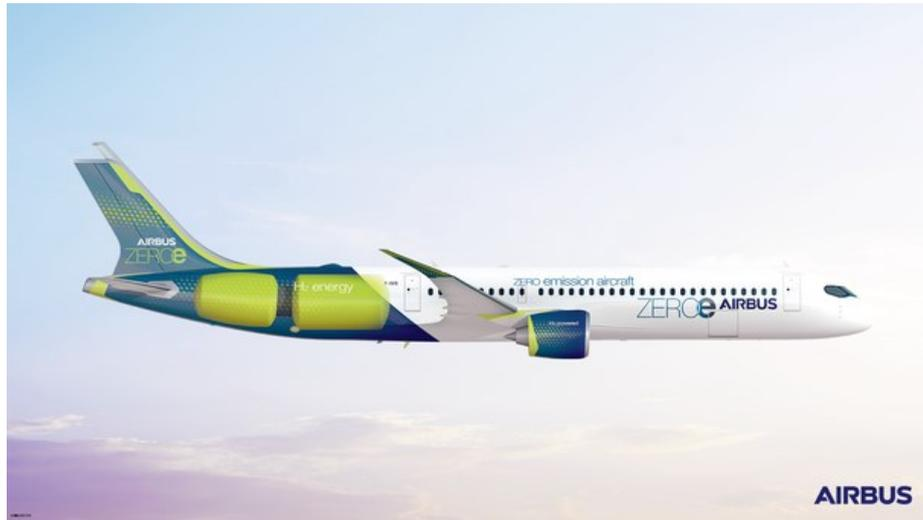
*Figura 1.4 Concept Airbus ZEROe con serbatoi di idrogeno liquido nella parte posteriore*
