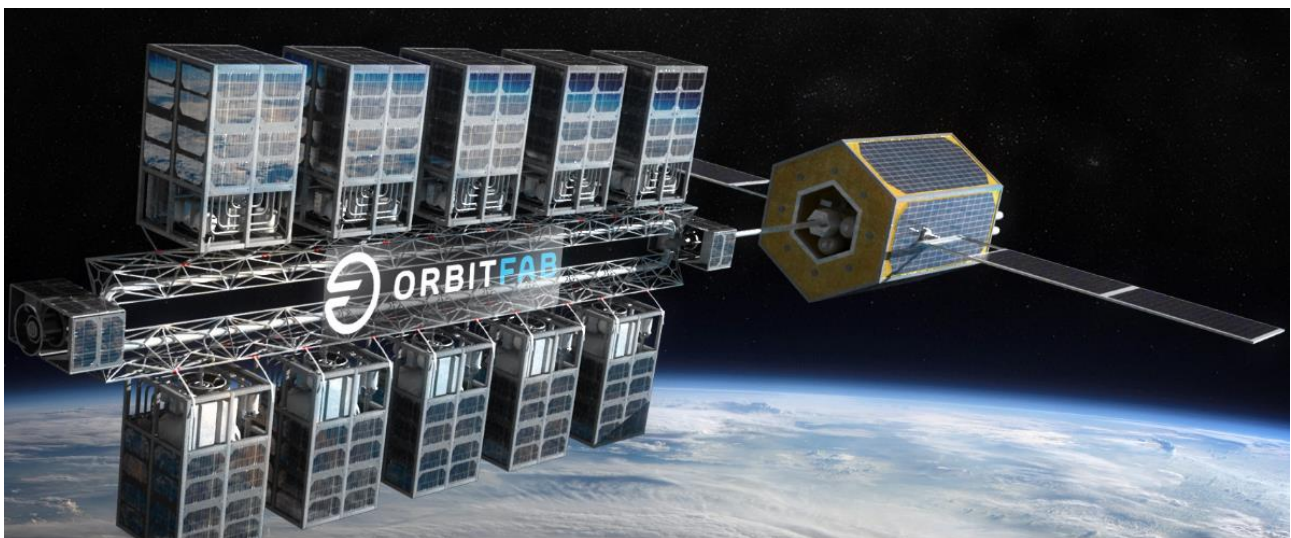
Figura 1.21: sistema di rifornimento di combustibile multi-satellite, orbitfab
