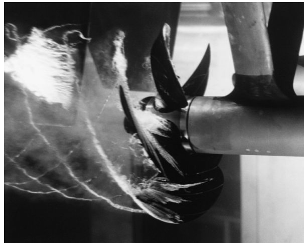
Figure 2.3: Esperimento presso David Taylor Model Basin circa il fenomeno della cavitazione di un'elica in una galleria ad acqua.
