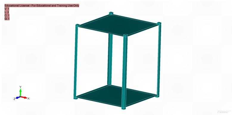
Figura 3.18: Caso spacecraft: modello CAD della scocca
