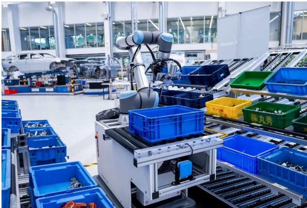
Figura 6.2: tecnologia MIRAI implementata su cobot UR, in una applicazione di pick&place con riconoscimento dei componenti
