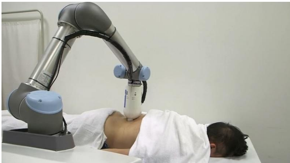
Figura 7.3: Cobot impiegato in attività di fisioterapia, per il trattamento diretto sul paziente
