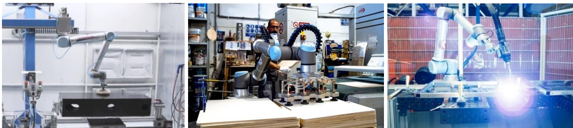
Figura 2.1: Diversi esempi di utensili applicati ai cobot. Partendo da sinistra vediamo un utensile per la finitura superficiale, un accessorio a ventose per la movimentazione ed un kit per la saldatura.
