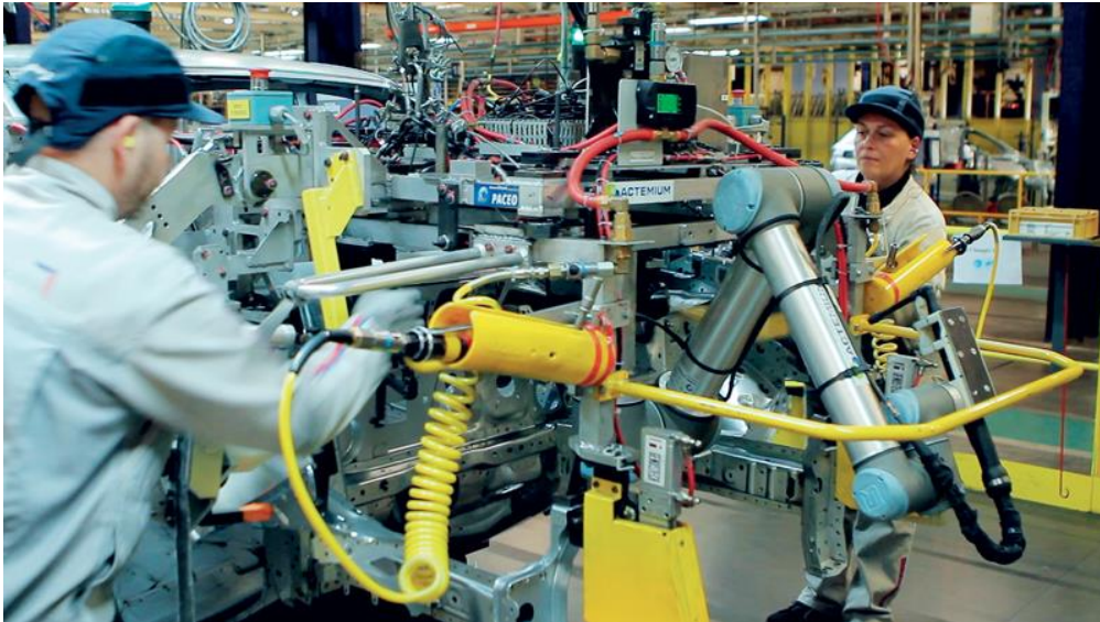
Figura 4.1: Collaborazione tra operai e cobot nello svolgimento di operazioni di assemblaggio su un telaio automobilistico.
