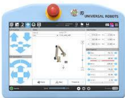
Figura 2.2: Teach Pendant della Universal Robots
