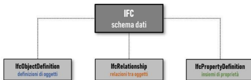
Figura 1.7: Schema dati gerarchico di un file IFC (ACCA Software 2023, 25 maggio)
