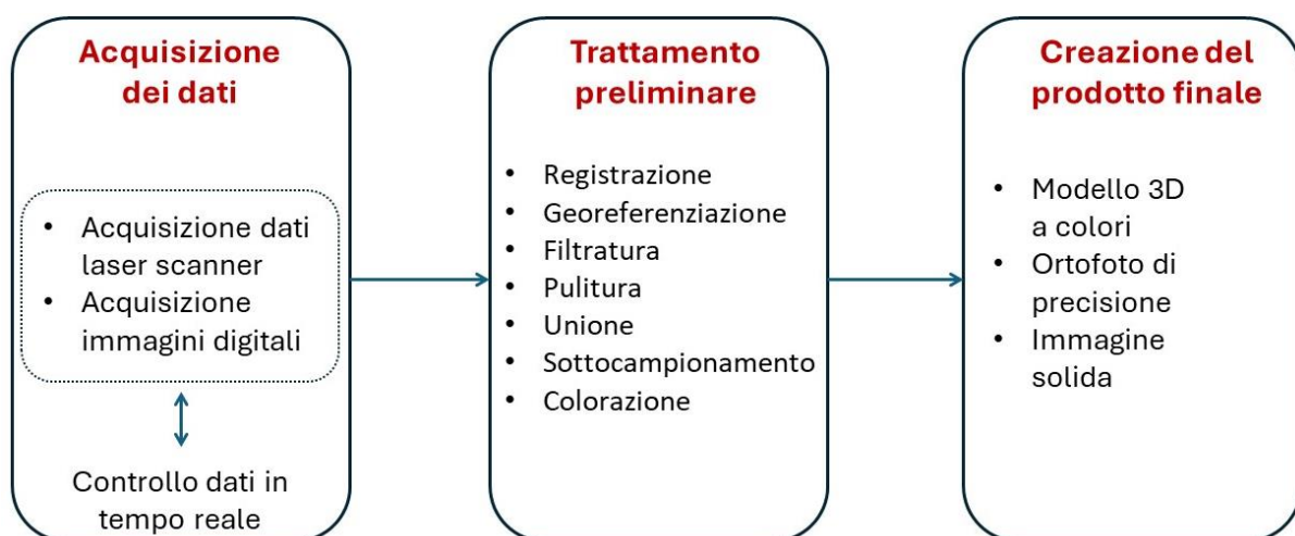
Figura 3-10 Organigramma del trattamento dati laser scanner [3.X].
