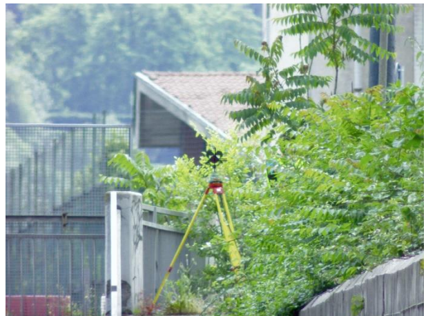
Figura 6-6 Prisma circolare posizionato su treppiede topografico e vincolato ad una rete topografica interna alla galleria.
