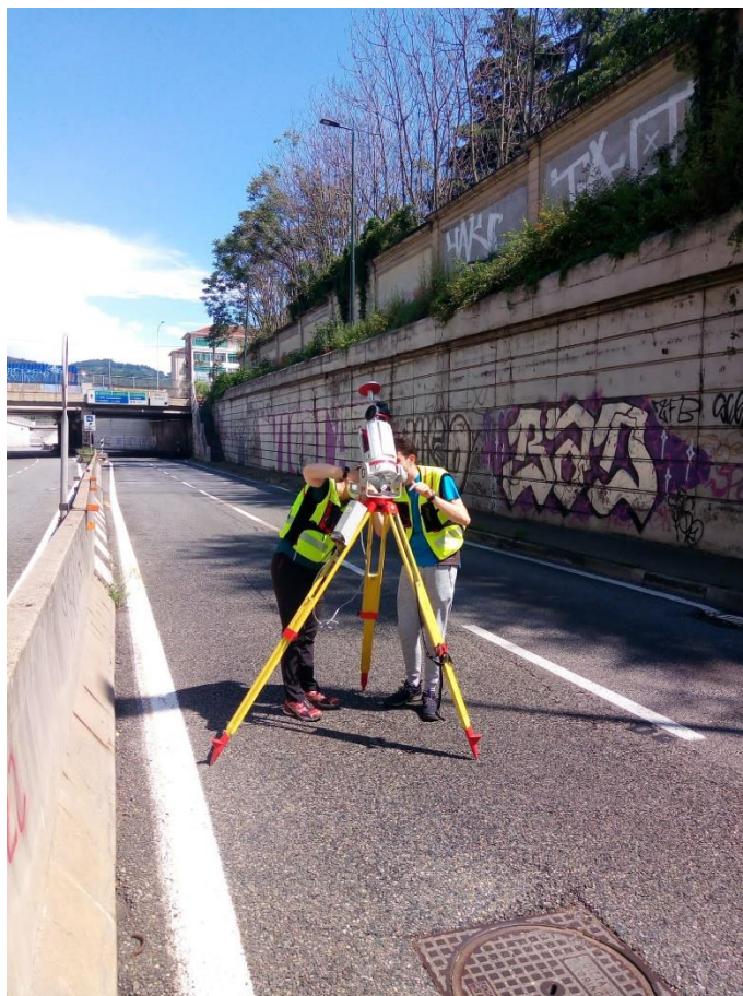
Figura 6-12 Posizionamento del Laser scanner su treppiede nella semicarreggiata ovest-est (da corso Giambone a Corso Unità d'Italia ScanPos01).
