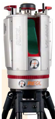
Figura 6-8 Laser Scanner Riegl VZ-400i impiegato durante la fase di acquisizioni con antenna GNSS.
