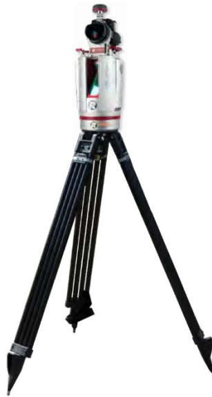
Figura 6-9 Laser Scanner Riegl VZ-400i con antenna GNSS e camera digitale Nikon D800 montato su un treppiede leggero in carbonio utilizzato come supporto per un flusso di lavoro rapido e fluido nell'acquisizione dei dati.
