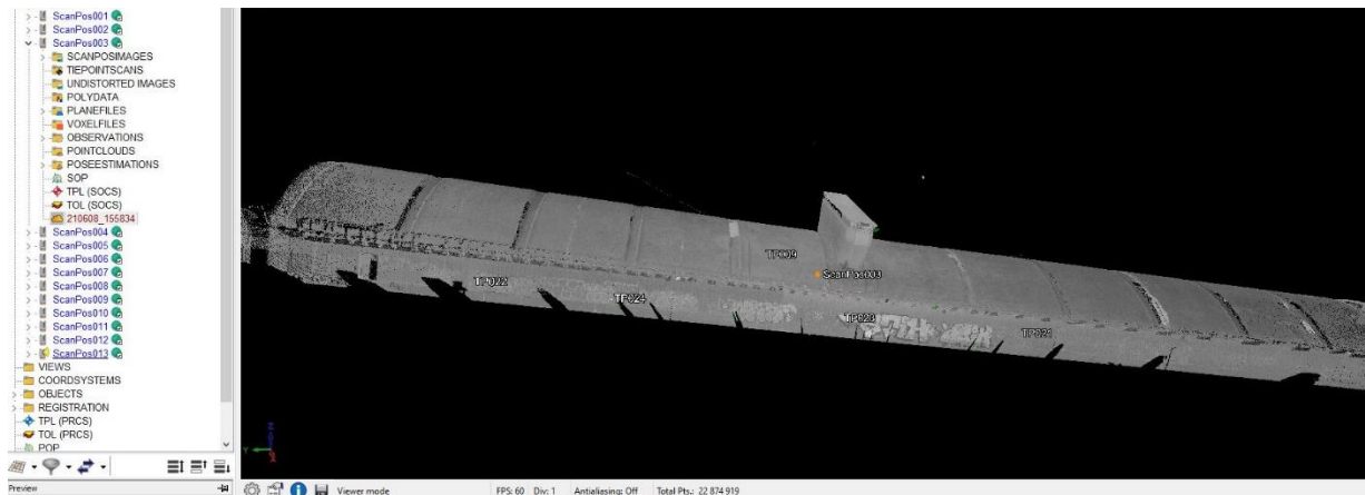
Figura 6-26 ScanPos003 e individuazione dei target riflettenti T1009, T1021, T1022, T1023 e T1024 in RiSCAN PRO®.
