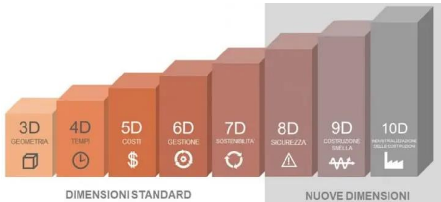
Figura 2-3 Le dimensioni del BIM, Fonte https://biblus.acca.it/le-dimensioni-del-bim/ .
