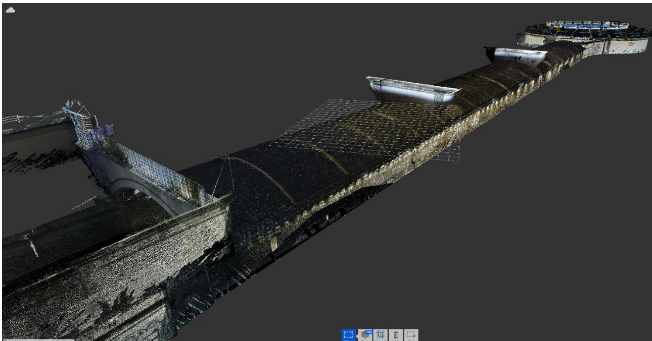
Figura 7-4 Visualizzazione della nuvola di punti in ReCap Pro: vista dall'alto del sottopasso del tratto scelto come caso studio dall'imbocco lato est alla rotonda Lingotto.
