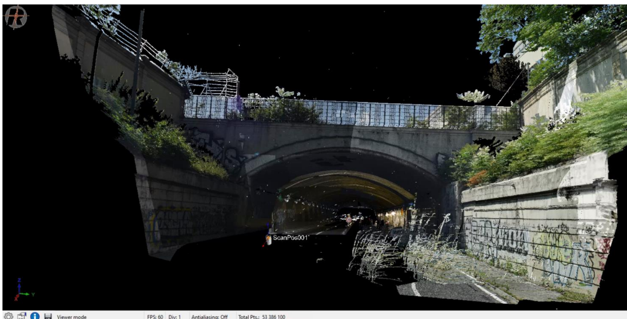
Figura 6-39 Nuvola di punti georeferenziata e colorata all'imbocco ovest del sottopasso Lingotto.
