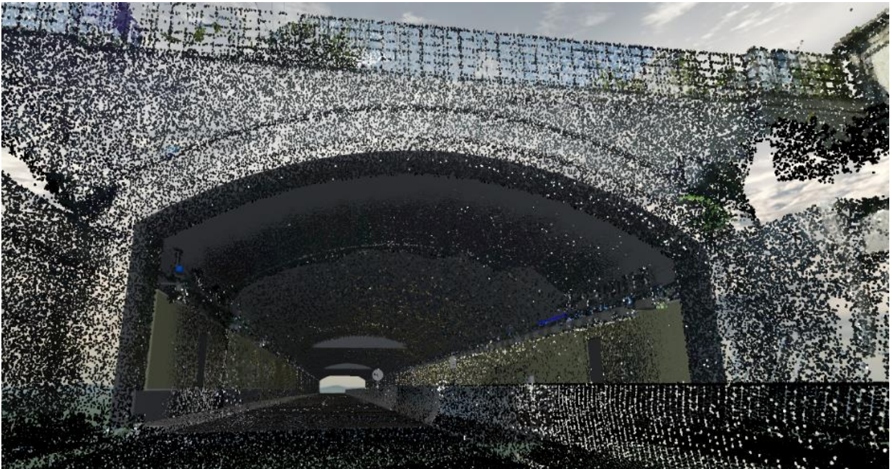
Figura 8-53 Visualizzazione del modello IFC importato in realtà virtuale (applicativo VREX PRO) con nuvola di punti georeferenziata dell'imbocco lato est del sottopasso lingotto.
