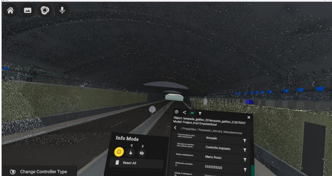
Figura 8-59 Visualizzazione in VREX PRO dei vari attributi all'interno del gruppo parametri relativi all'attività di manutenzione per il dispositivo di illuminazione
