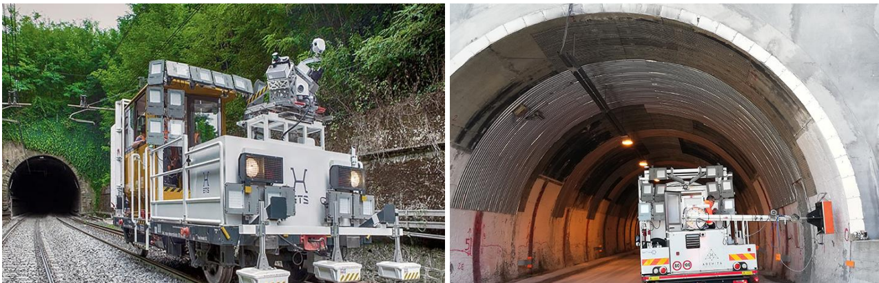
Figura 3-17 Esempio di MMV ARCHITA per gallerie ferroviarie (a sinistra) e stradali (a destra) [21].
