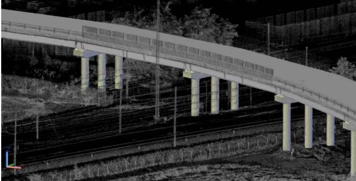
Figura 3-12 Esempio di nuvola di punti ottenuta di un viadotto stradale seguendo la procedura di elaborazione dati all'interno del software RiSCAN PRO (Fonte, ConsulCAD S.r.l.).
