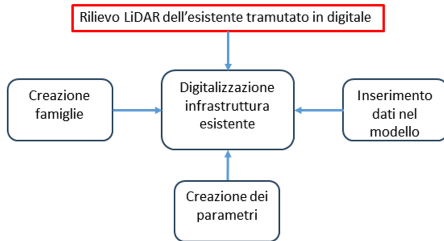
Figura 5-25 Workflow seguito per la creazione del modello as-is per attività manutentive.
