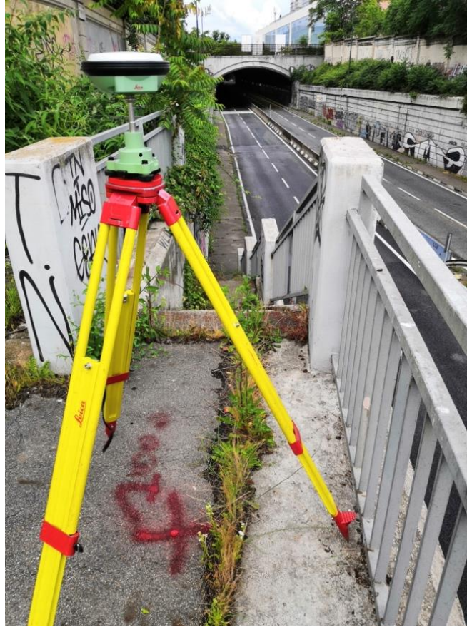
Figura 6-4 Stazionamento con treppiede e ricevitore GNSS Leica GS14 sul vertice "1000" materializzato a terra con centrino.
