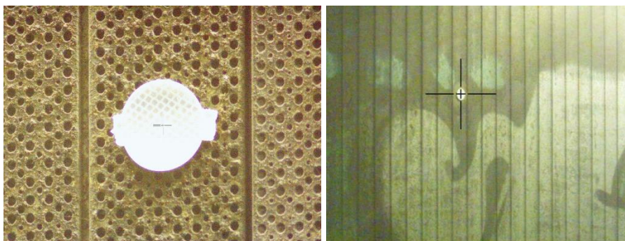
Figura 6-7 Esempio di target retroriflettente utilizzato durante i rilievi all'interno del tunnel per la registrazione e colorazione delle scansioni.
