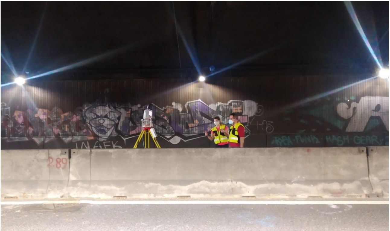
Figura 6-13 Posizionamento del laser scanner all'interno del sottopasso Lingotto (ScanPos005) inclinato di 30° rispetto all'orizzontale. In alto a destra dell'immagine vedere sulla parete del tunnel un target retroriflettente (T1006).
