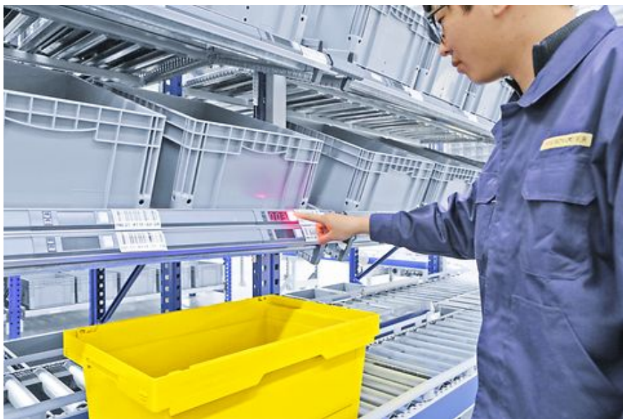
Figura 3.2: Picking manuale con tecnologia "pick-to-light"
