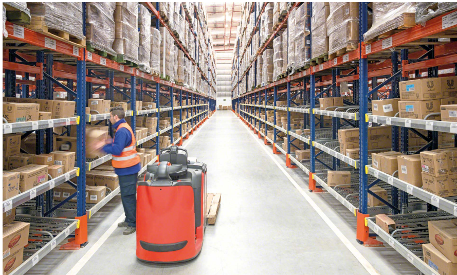
Figura 3.1: Picking con metodo pickers-to-parts
