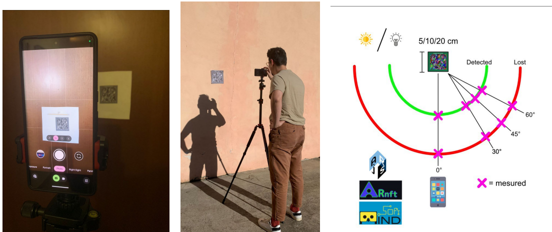
Figura 5.1: Setup per DD/LD con luce artificiale (a destra) e naturale (centrale), schema misurazioni (a destra)
