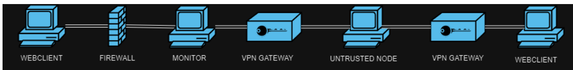
Figura 2.1. Esempio di Service Function Chain
