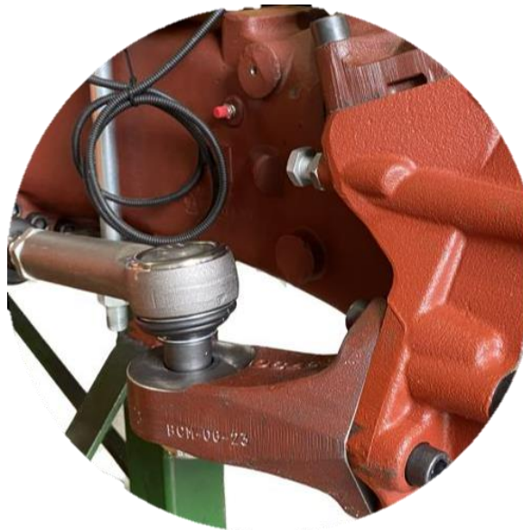
Figura 4.3 - Montaggio errato del giunto sferico di collegamento meccanico tra braccetto di sterzo e mozzo ruota
