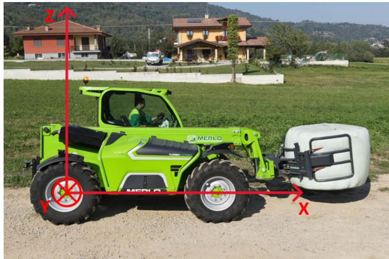
Figura 6.2 - Sistema di riferimento globale del mezzo telescopico in esame
