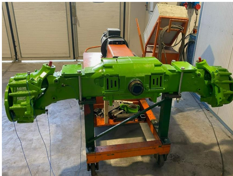
Figura 5.2 - Focus su sistema di sostegno strutturale e di vincolo dell'assale su banco prova
