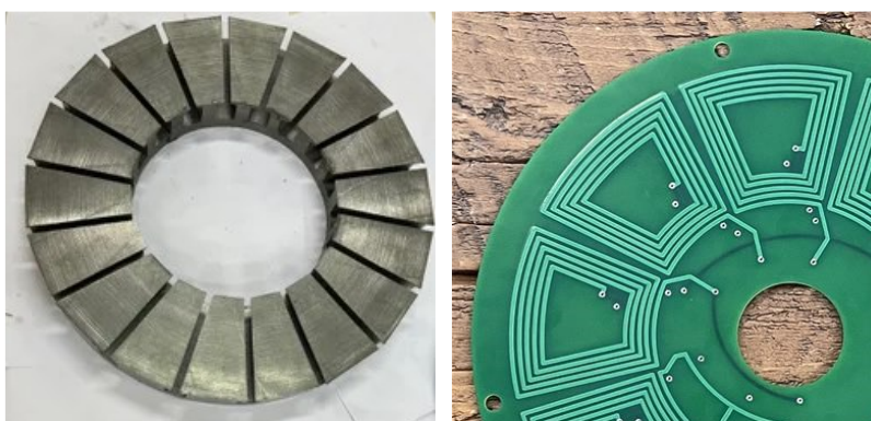
FIGURA 3.4 Confronto tra uno statore laminato e uno statore a circuito stampato
