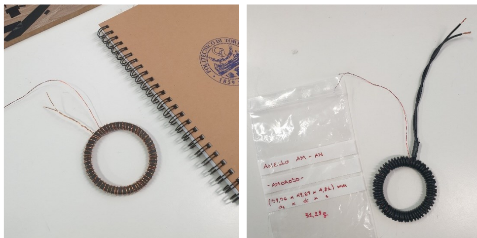
FIGURA 4.8 Preparazione del campione completa con avvolgimento primario smaltato (a sinistra) e gommato (a destra)
