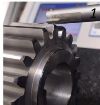
Figura 77 - misure rugosità superficiale: punti di misurazione (sx) [41], rugosimetro (dx) [42]
