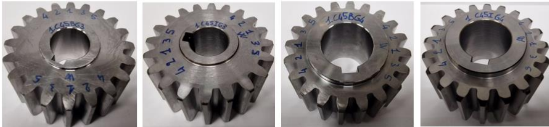
Figura 73 - ingranaggi C45: modulo 3 base e temprato (sx), modulo 4 base e temprato (dx)
