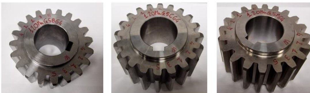
Figura 75 - ingranaggi 20MnCr5 modulo 4: base, cementato, pallinato
