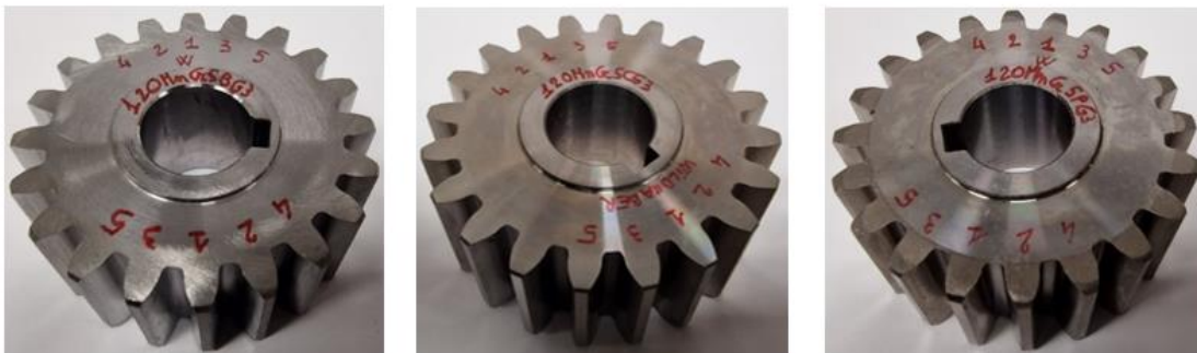
Figura 74- ingranaggi 20MnCr5 modulo 3: base, cementato, pallinato
