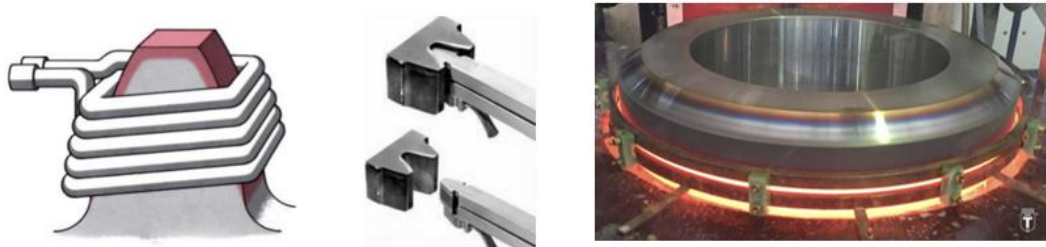
Figura 24 - tempra ad induzione per ingranaggi meccanici: dente per dente [13] [14] (sx), tempra rotativa (dx) [15]
