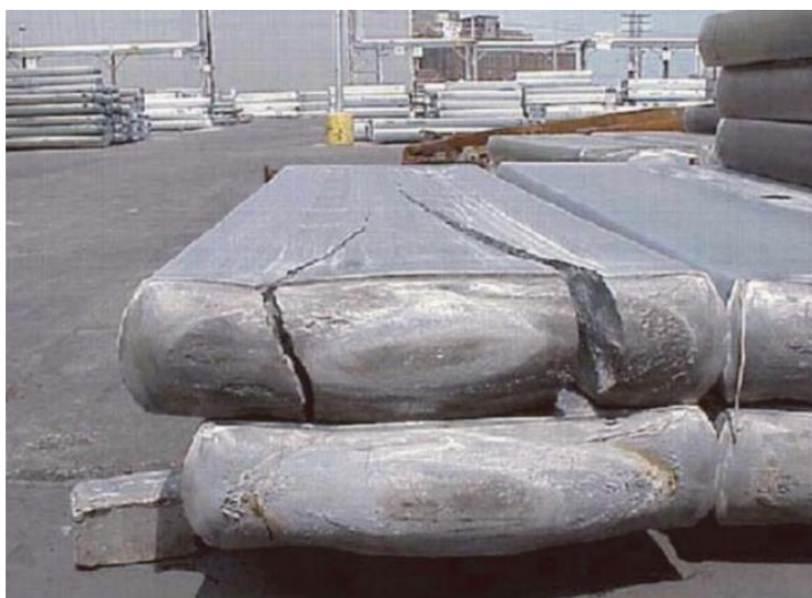
Figura 4 - esempio di effetti nocivi delle tensioni residue [5]
