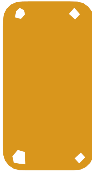
Figura 3.4: Una delle quattro piastre di fissaggio della crash box ai longheroni.
