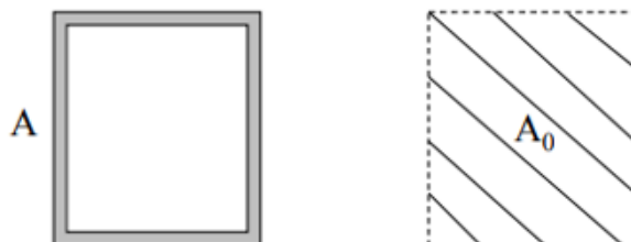
Figura 2.3: Area piena della crash box e area totale racchiusa dal profilo.
