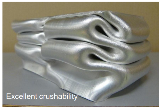
Figura 1.3: Sopra una crash box realizzata con un alluminio con scarse proprietà di schiacciamento, mentre in basso si può apprezzare l'ottimo comportamento della lega TL116-C24-T6.
