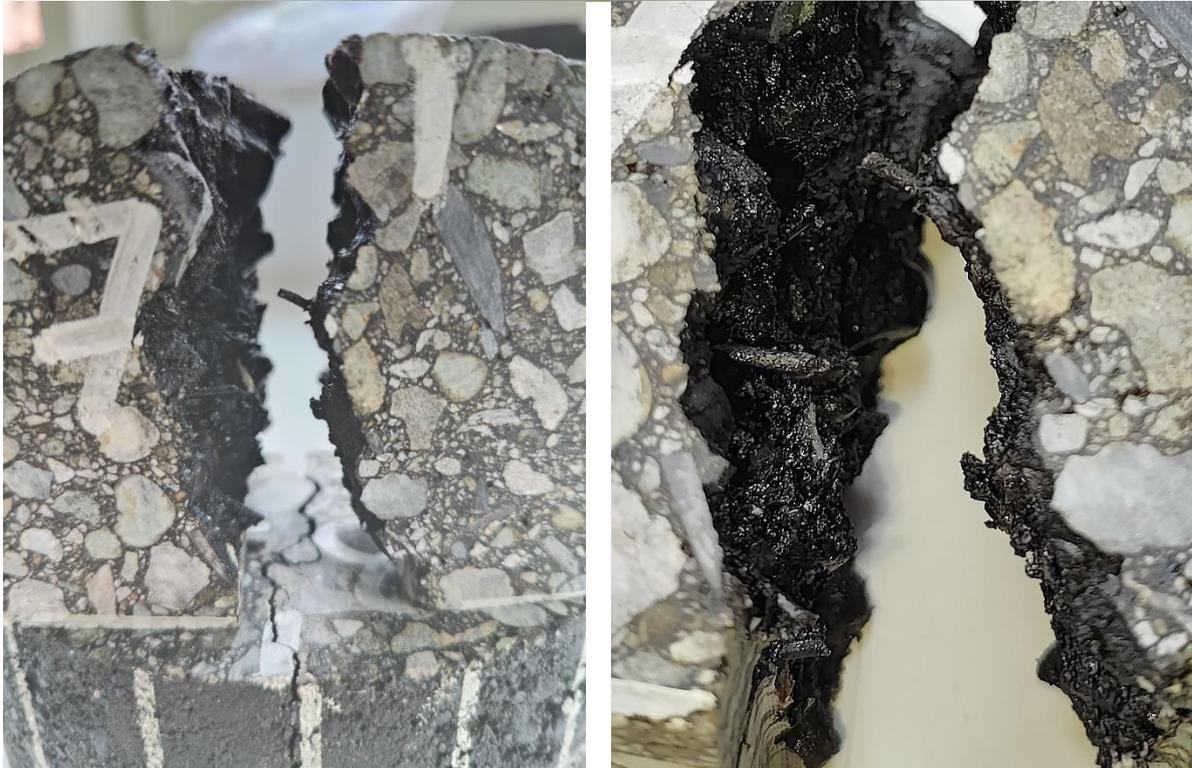
**Figura 99.** Sopra: Rottura del provino con fibre. Sotto: Vista da vicino. Fibre all'interno del campione F7 SCB dopo la frattura.
