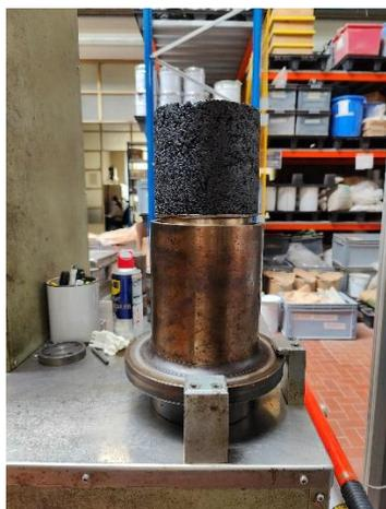
**Figura 74.** Campione compattato  $150 \times 115 \text{ mm}^2$  per SCB test.
