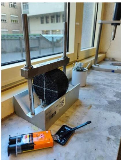
**Figura 69.** Dispositivo per l'incollaggio delle barrette di acciaio per LVDT.
