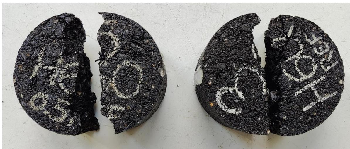
**Figura 93.** Rottura per fatica, confronto tra miscela di riferimento (a destra) e miscela con 0.5% fibre (a sinistra).
