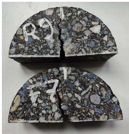
**Figura 98.** SCB. Riferimento sopra e fibre sotto.
