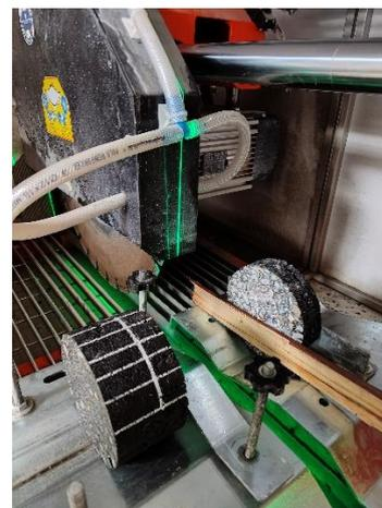
**Figura 76.** Configurazione taglio tramite sega circolare.
