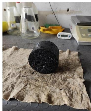
**Figura 51.** Asciugatura della superficie del campione per SSD,  $m_3$ .
