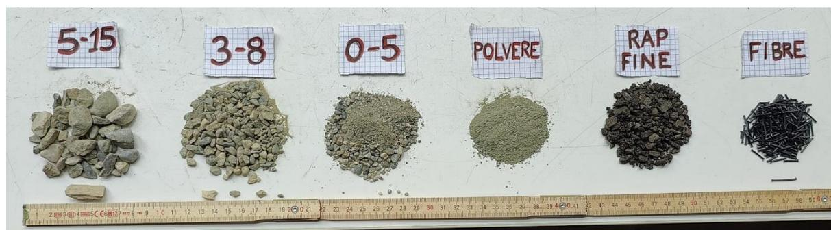
**Figura 18.** Dimensioni delle classi di aggregati e lunghezza delle fibre.
