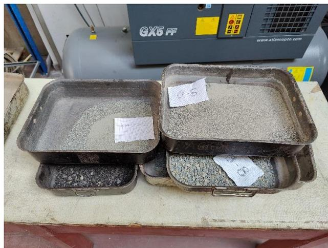
**Figura 28.** Classe di aggregati dopo l'analisi granulometrica
