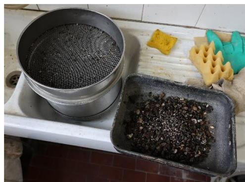
**Figura 41.** Lavaggio degli aggregati post-ignizione.
