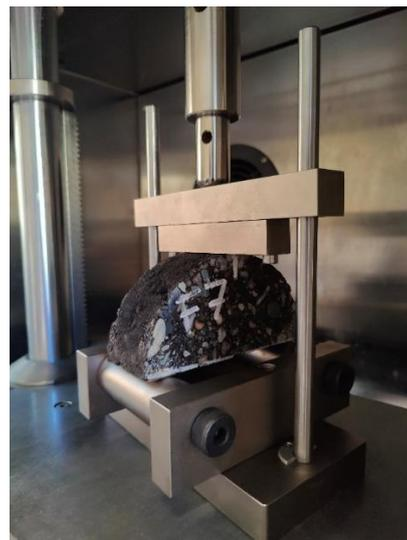
**Figura 82.** Applicazione del carico sul provino SC con fibre.
