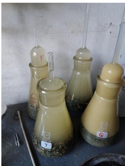
**Figura 22.** Aggregati nei picnometri dopo la deaerazione.
