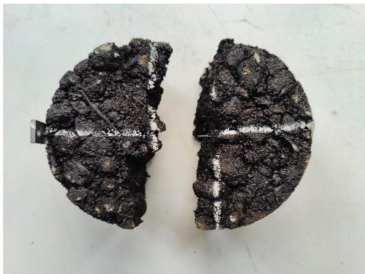
**Figura 73.** Rottura per fatica del campione con fibre.
