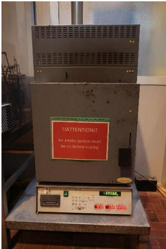
**Figura 37.** Carbolite con temperatura di 540°C.
