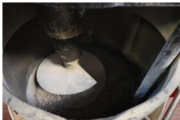
**Figura 57.** Miscelazione di soli aggregati.
