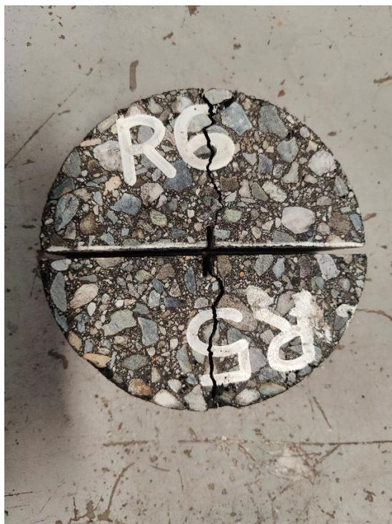
**Figura 84.** Fessurazione dei provini SC.
