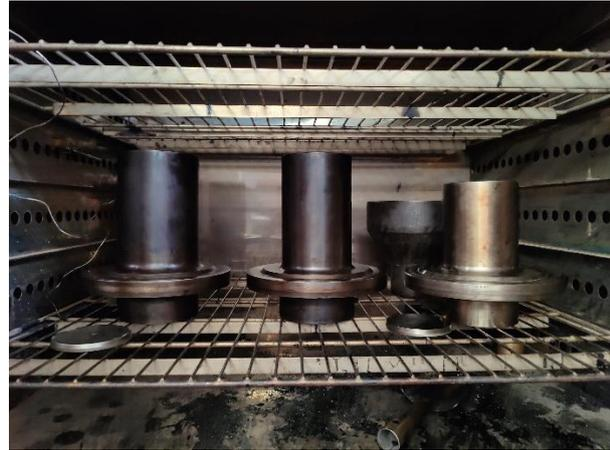
**Figura 46.** Riscaldamento di fustelle da 100 mm in forno a 150°C.
