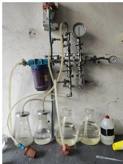
**Figura 21.** Deaeratore e sotto picnometri con acqua distillata e deaerata.
