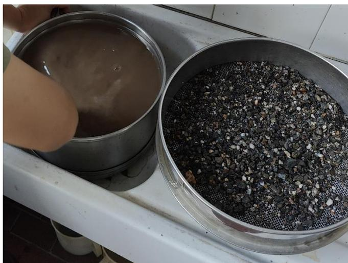
**Figura 25.** Fase di lavaggio degli aggregati.
