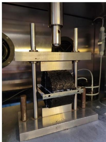
**Figura 70.** Configurazione di prova di fatica CIT-CY.
