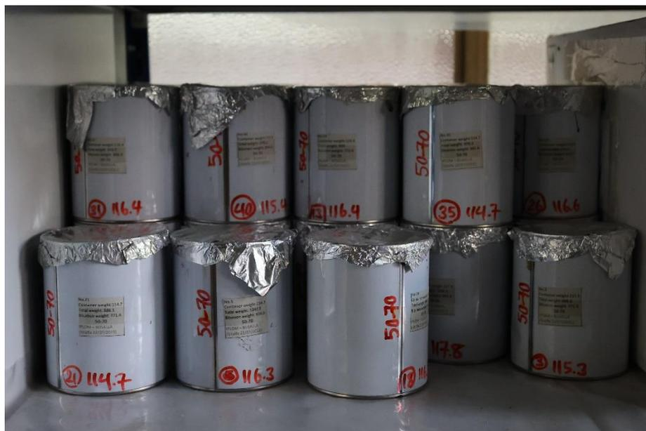
**Figura 29.** Contenitori di alluminio contenente il bitume 50/70 da IPLM-Busalla
