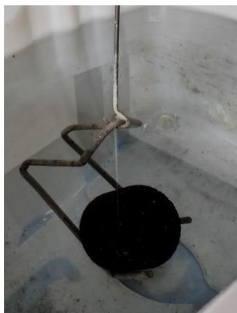
**Figura 50.** Pesatura in acqua,  $m_2$ .
