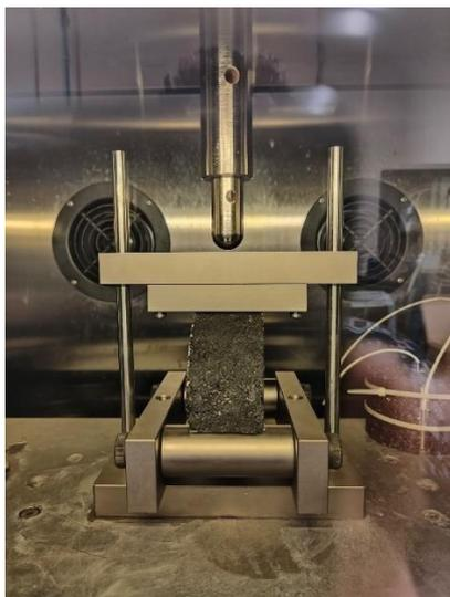
**Figura 81.** Configurazione di prova SCB.
