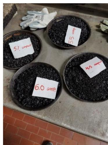
**Figura 31.** Miscele con diverso dosaggio di bitume alla fine della miscelazione.
