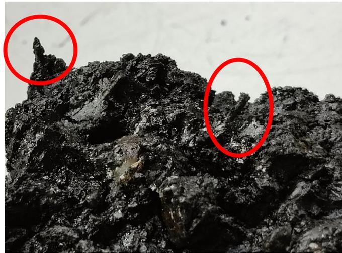
**Figura 95.** Vista da vicino. Fibre nel campione rotto dopo il test di fatica.
