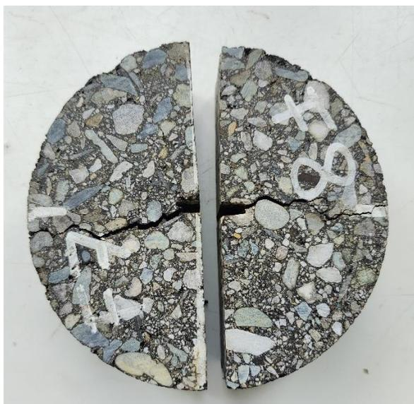
**Figura 97.** Campioni SC con fibre, dopo la rottura a flessione.
