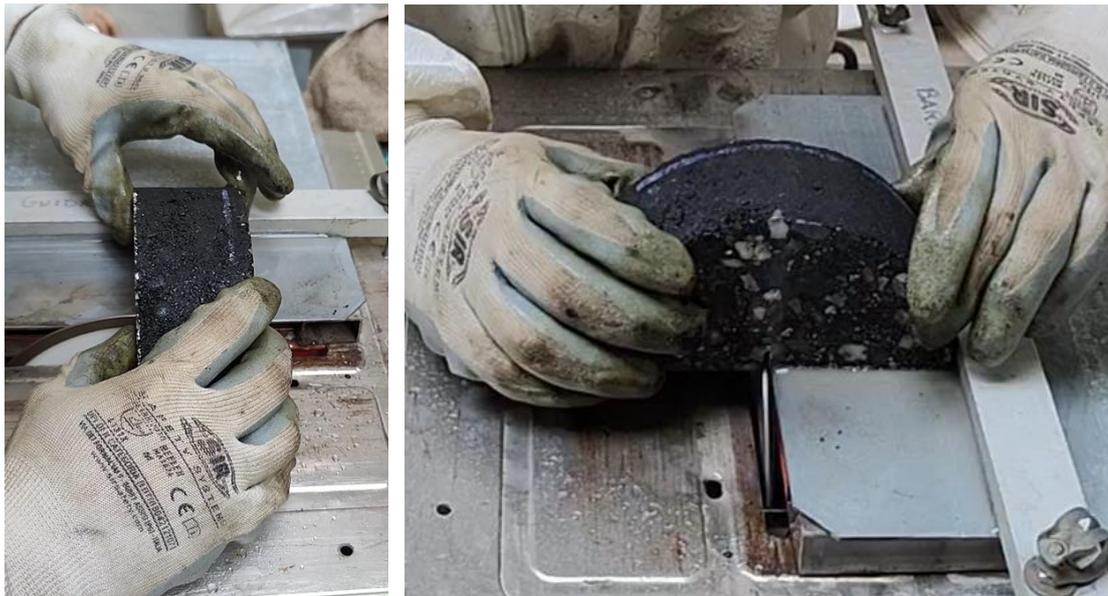
**Figura 80.** Notch su campioni semicircolari per SCB test.
