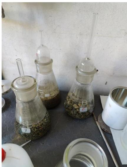
**Figura 20.** Sedimentazione delle particelle nei picnometri con acqua distillata.
