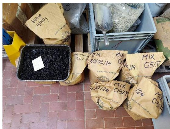
**Figura 63.** Le due miscele ottenute, di riferimento e con 0.5%Fibre.
