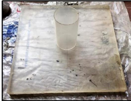
*Figura 3.9: cilindro e piatto usati per il test di spandimento*
