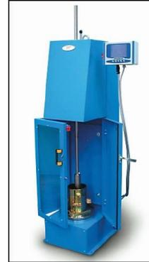
*Figura 3.5: compattatore meccanico*
