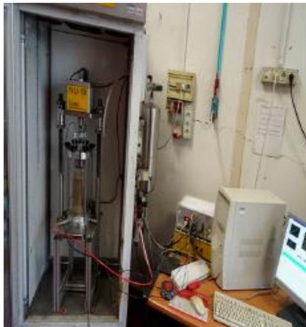
*Figura 3.15: impianto di prova triassiale utilizzato per il test del modulo resiliente*
