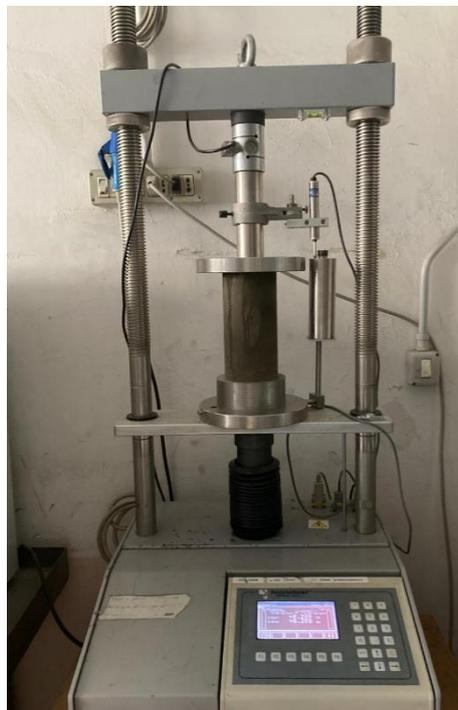
*Figura 3.18: macchina per test UCS*
