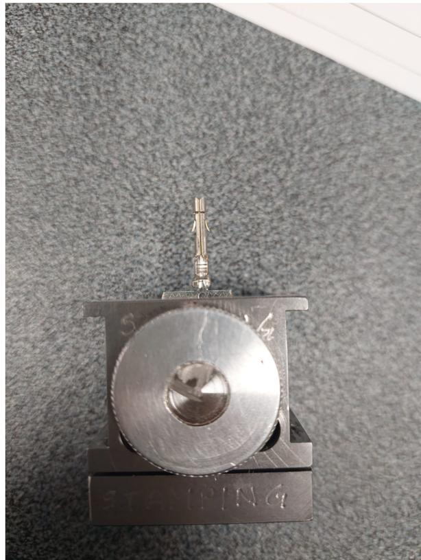
**Figura 5.10:** Posizionamento corretto del campione nel tool
