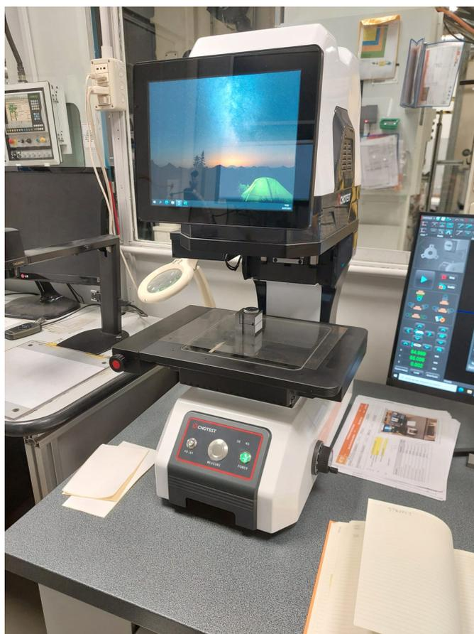
**Figura 4.5:** Macchina di misura ottica "Flash" del produttore RUPAC, presente in azienda
