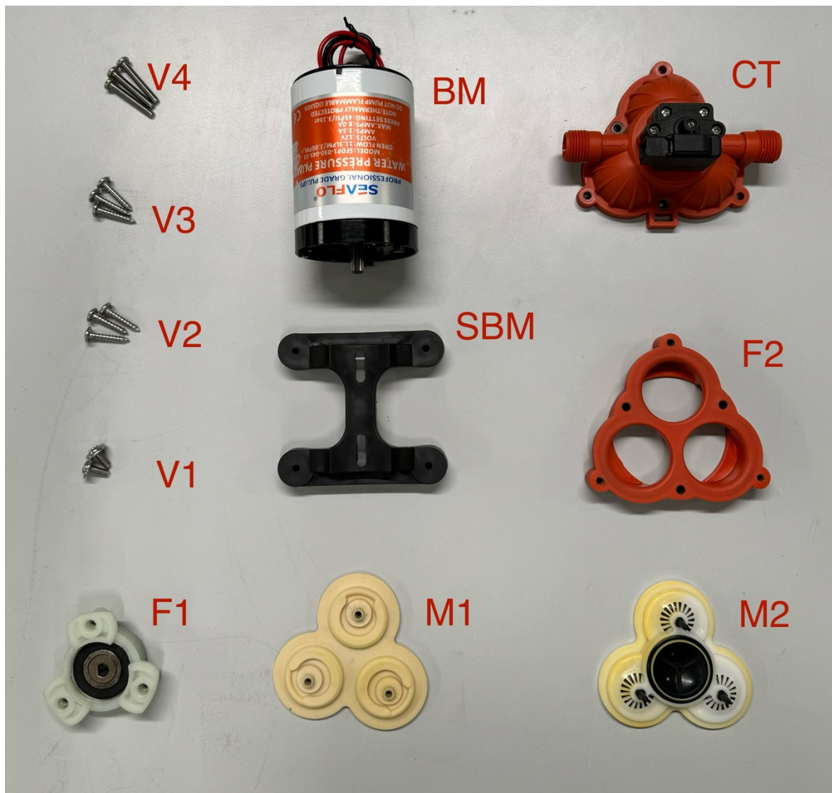
Figura 5.2 - Componenti della pompa a membrana
