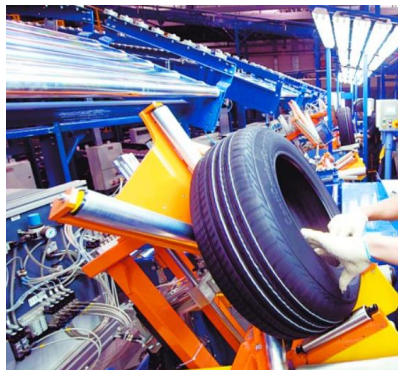
Figure 26: Controllo visivo copertura su divaricatore
