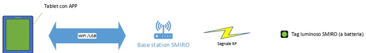
Figura 70 - Comunicazione del segnale Pick to light Smiro System
