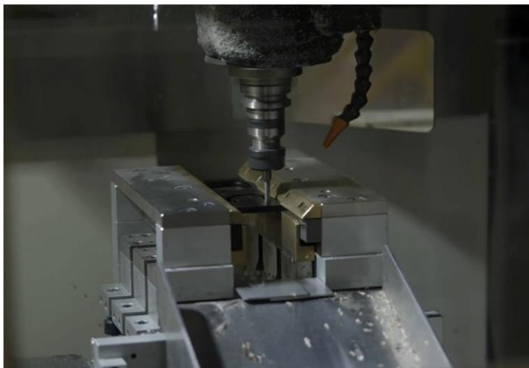
*Figura 96 - Fresatura interna
