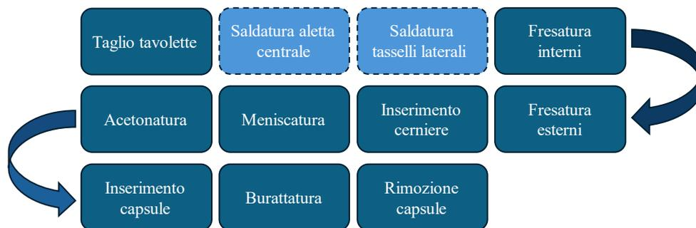
Figura 16 - Processo produttivo di un occhiale in acetato (Grizzo Frontale)
