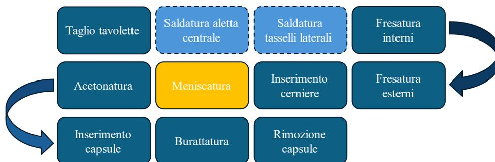
Figura 48 - Il processo produttivo di un occhiale in acetato: la meniscatura (Grezzo Frontale)
