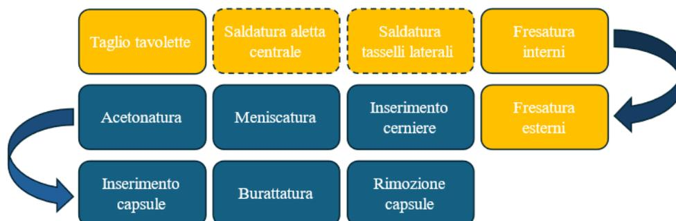
Figura 92 - Processo produttivo di un occhiale in acetato: le lavorazioni dell'area grezzo frontali analizzate nel caso studio
