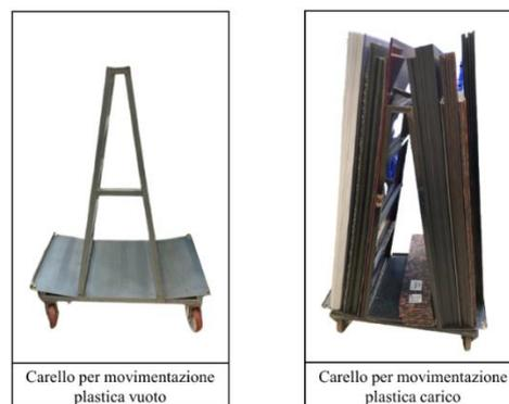
Figura 99 - Carrelli per la movimentazione delle plastiche
