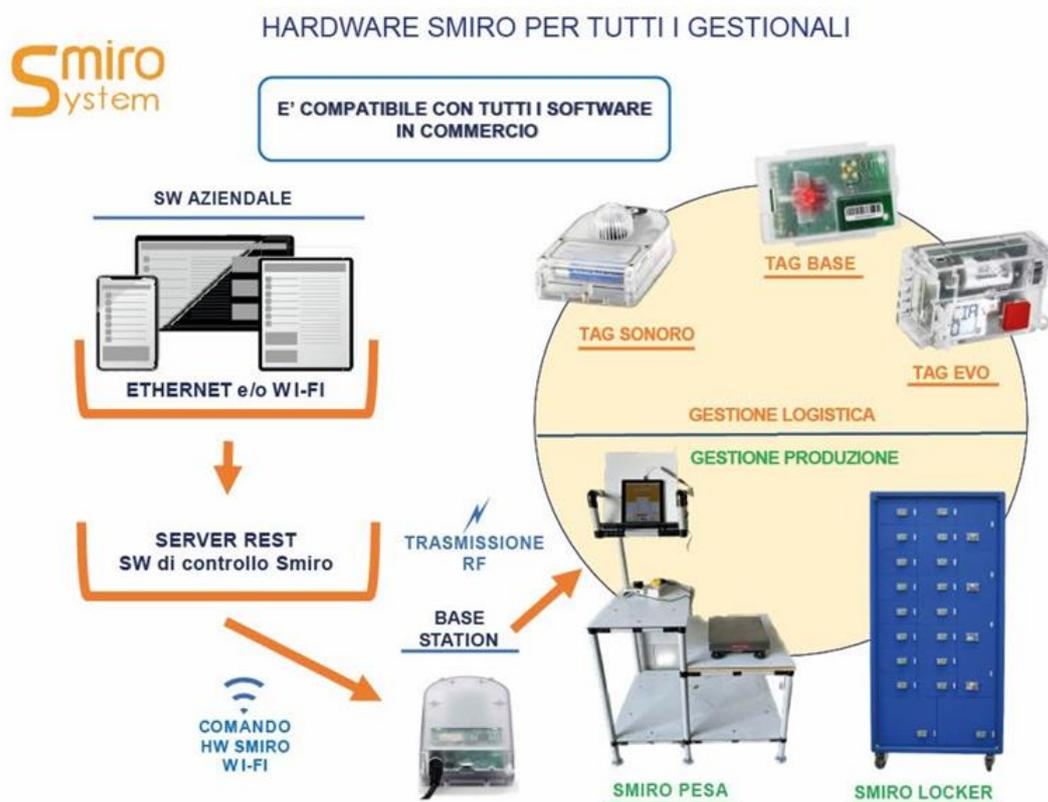
Figura 66 - Funzionamento e hardware Smiro
