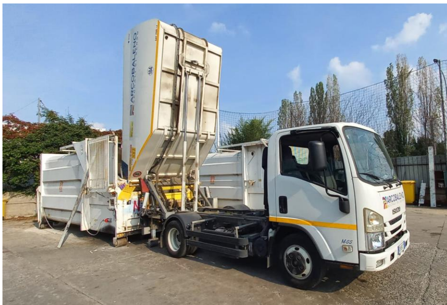
Figura 3.6: Conferimento dei rifiuti al centro di raccolta mediante il cilindro telescopico che porta la vasca ad una sufficiente elevazione
