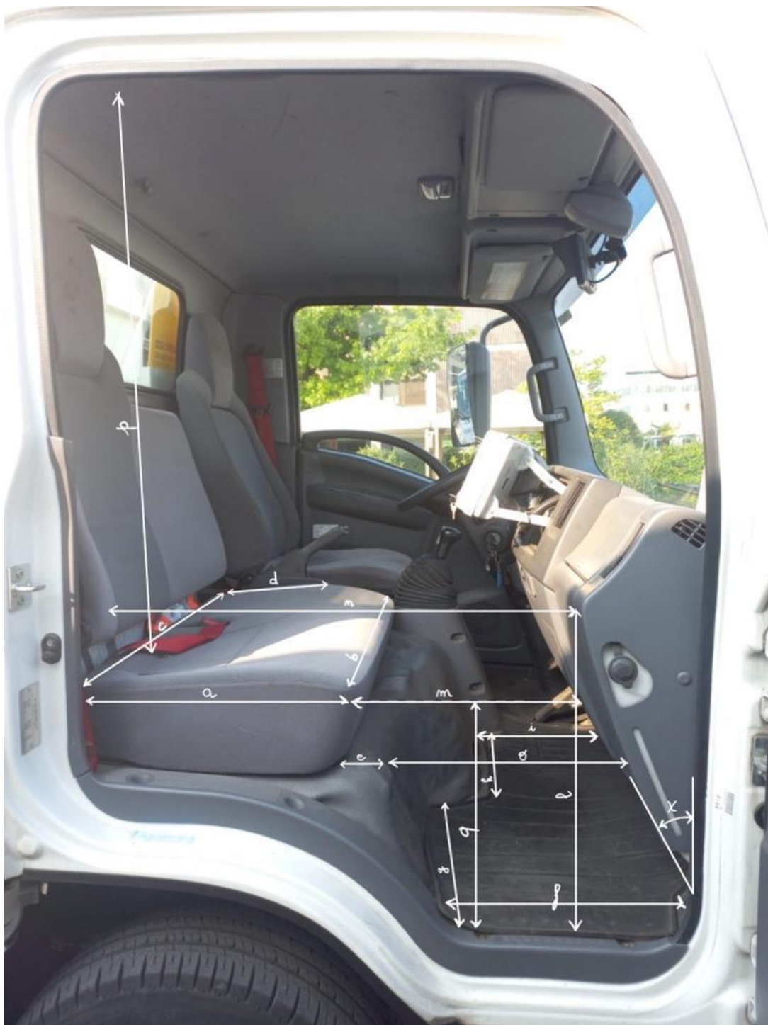
Figura 3.16: Schema con le misure della cabina di un minicompattatore
