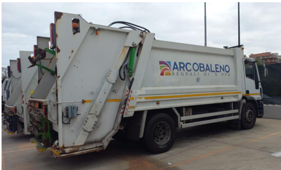
Figura 3.12: Compattatore con capacità di 16 metri cubi e con peso totale a terra di 180 quintali
