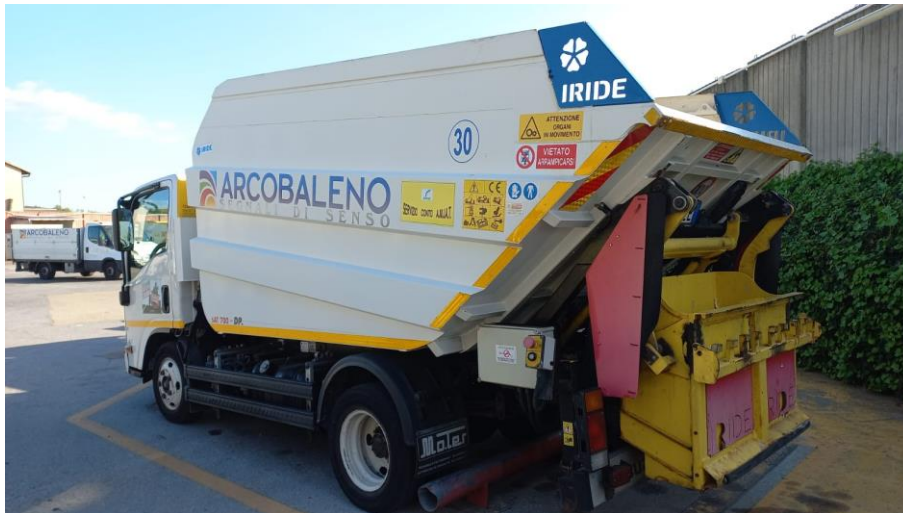
Figura 3.13: Minicompattatore con capacità di 7 metri cubi e peso totale a terra di 35 quintali
