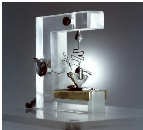
Figura 15. Il primo transistor al mondo.
