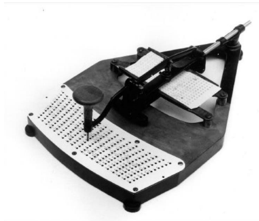
Figura 5. Perforatore di schede a pantografo. Fonte: Archivio storico IBM Italia.
