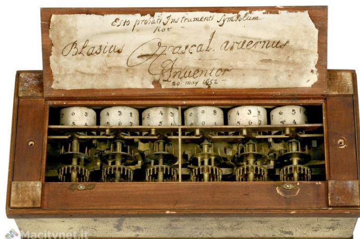
Figura 1. La prima macchina calcolatrice della storia: la Pascalina.
