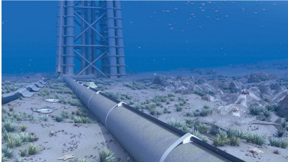
Figura 17: Riproduzione grafica 3D di una sealine a servizio di una piattaforma offshore [36].
