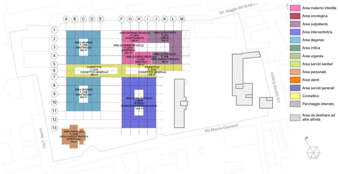
Fig. 73 – Distribuzione funzionale – Pianta piano primo. FONTE: Elaborazione dell'autore.
