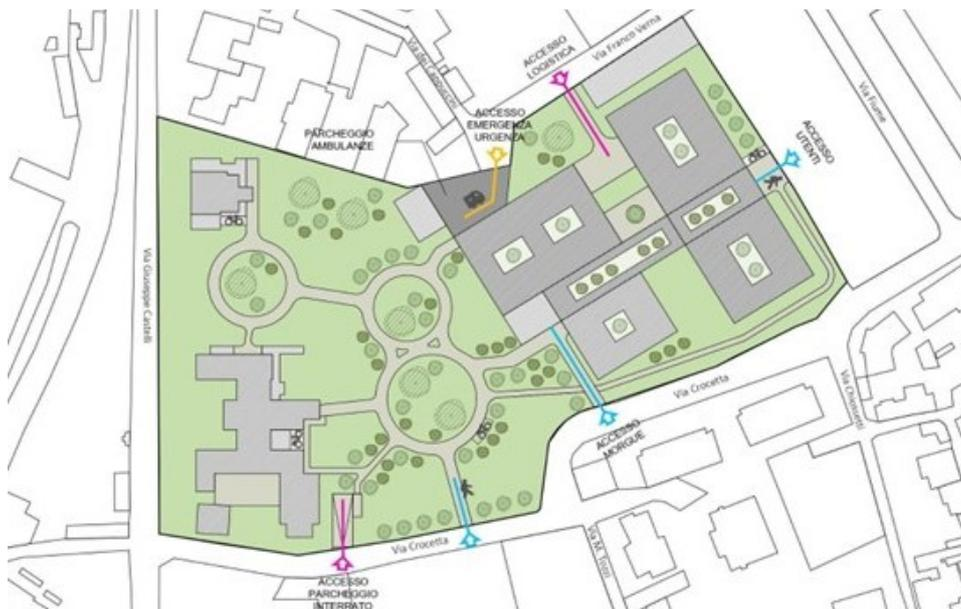
Fig. 84 – Masterplan di progetto con indicazione dei diversi accessi e percorsi interni. FONTE: Elaborazione dell'autore.
