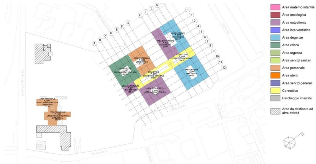
Fig. 89 – Distribuzione funzionale – Pianta piano secondo. FONTE: Elaborazione dell'autore.
