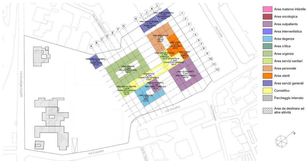
Fig. 87 – Distribuzione funzionale – Pianta piano terra. FONTE: Elaborazione dell'autore.
