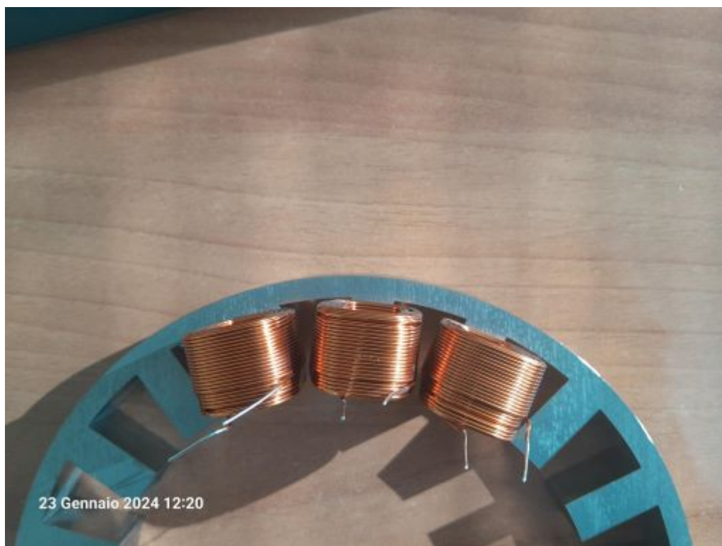
Figura 3.26: Valutazione dell'interferenza tra le bobine
