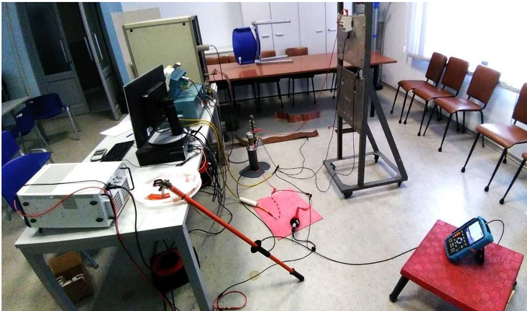
Figura 6-9: Zona prova per analisi fenomeno di scarica con interruttore
