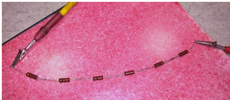
Figura 5-15: Sei resistenze ognuna da 570 \Omega in serie al generatore sinusoidale
