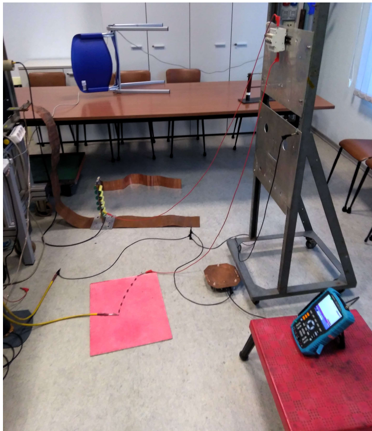
Figura 9-8: Disposizione dispositivi per acquisizione con sonda di campo
