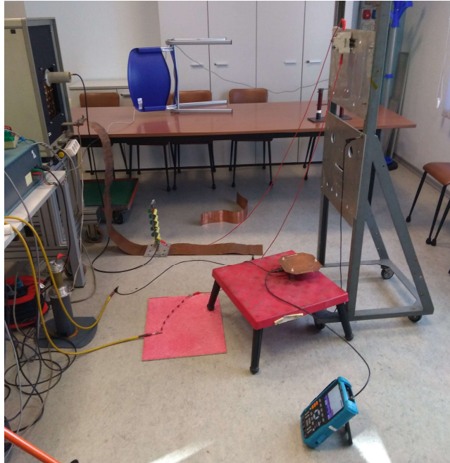
Figura 9-12: Miglioramento disposizione apparecchiatura per acquisizione con sonda di campo
